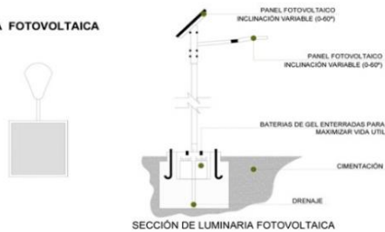
SECCIÓN DE LUMINARIA FOTOVOLTAICA
