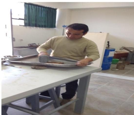
*Figura 22* Trituración de muestras para tamizado
