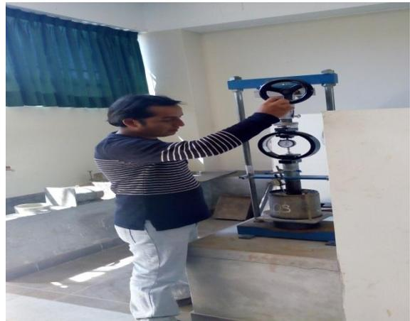
**Figura 28** Lectura de Penetración para CBR
