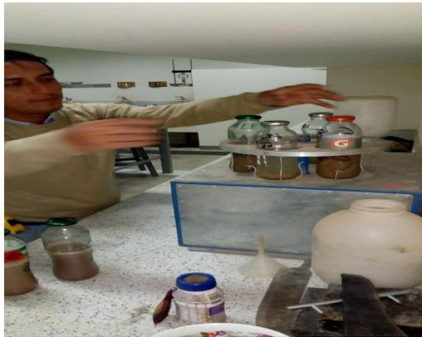
*Figura 26* Colocación de muestras en máquina agitadora para determinación del Contenido de Sales
