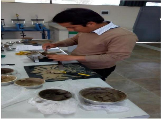
**Figura 23** Determinación de Limite Líquido
