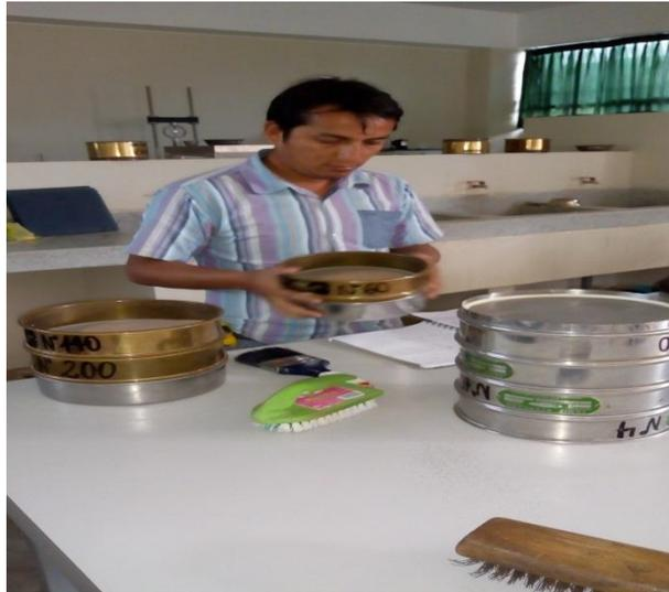
*Figura 25* Ensayo de Granulometría
