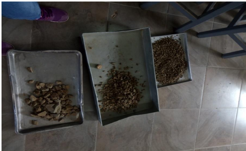
Figura 44. Material retenido en las mallas \frac{3}{4} ", \frac{3}{8} " y N°4.
