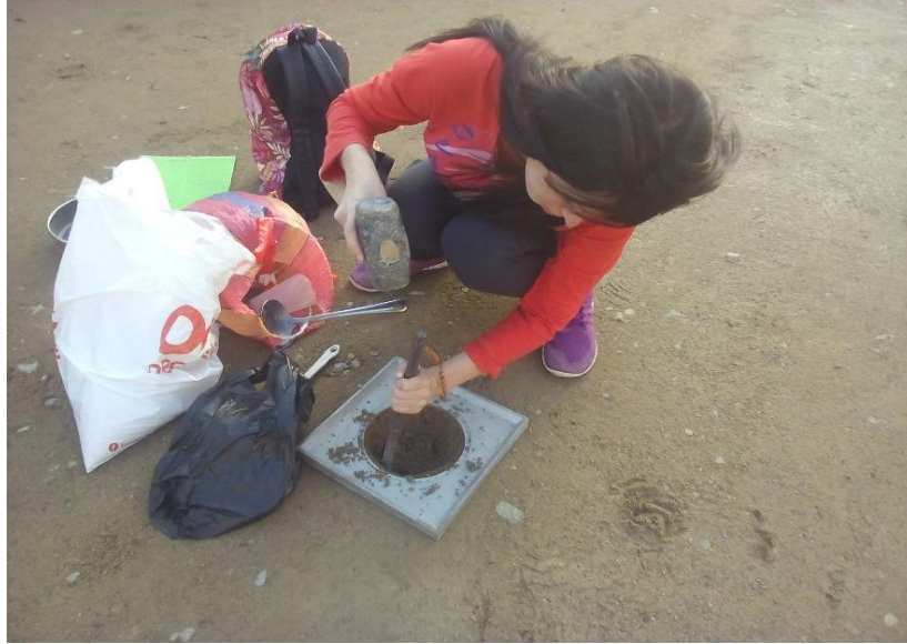
Figura 81. Excavación de agujero de 15 cm de profundidad – Zona1.
