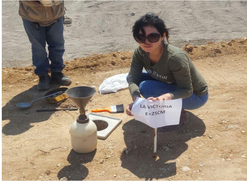
Figura 87. Prueba de densidad de campo – Zona 2.
