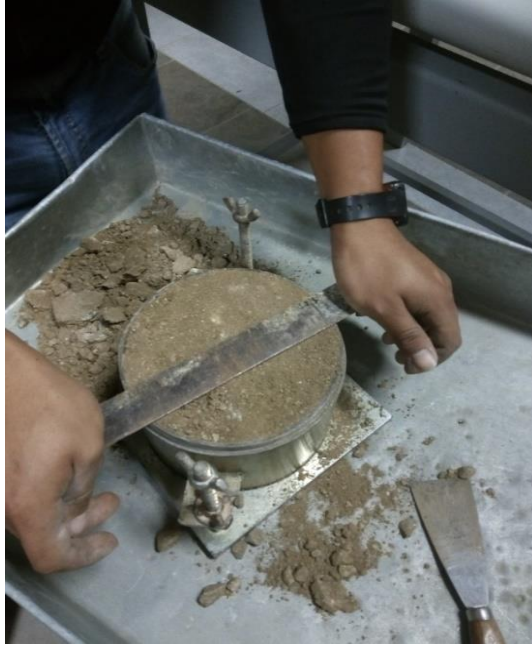
Figura 55. Desmolde y nivelación de la muestra compactada.
