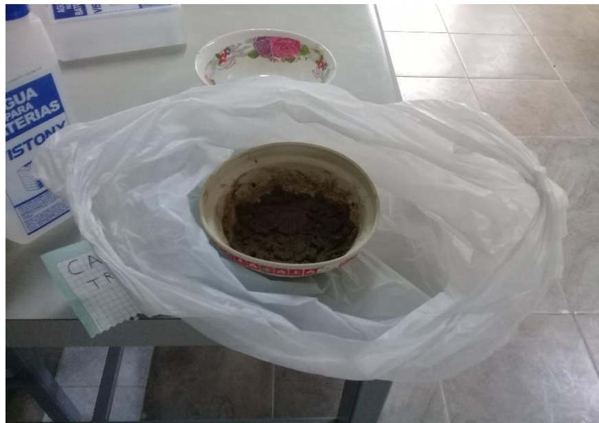
Figura 58. Saturación de la muestra.
