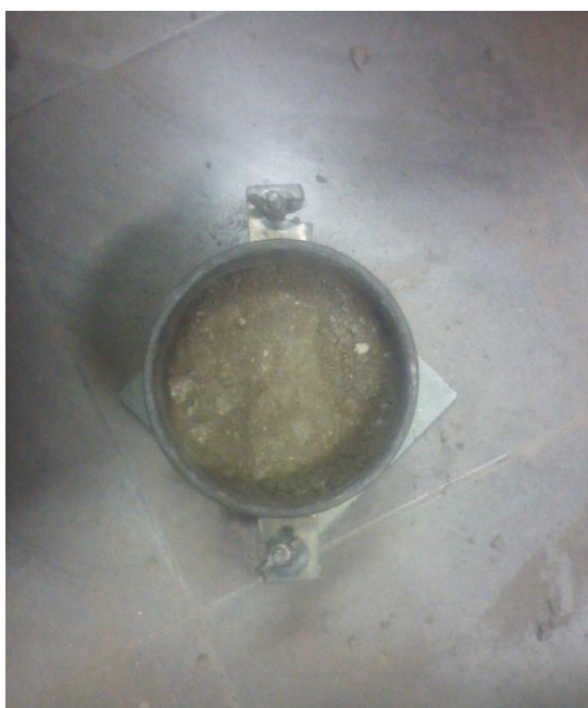
Figura 53. Primera capa compactada con 56 golpes con pisón de 10 lb.
