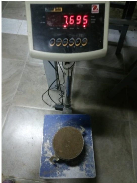
Figura 56. Peso del molde sin base más la muestra compactada.
