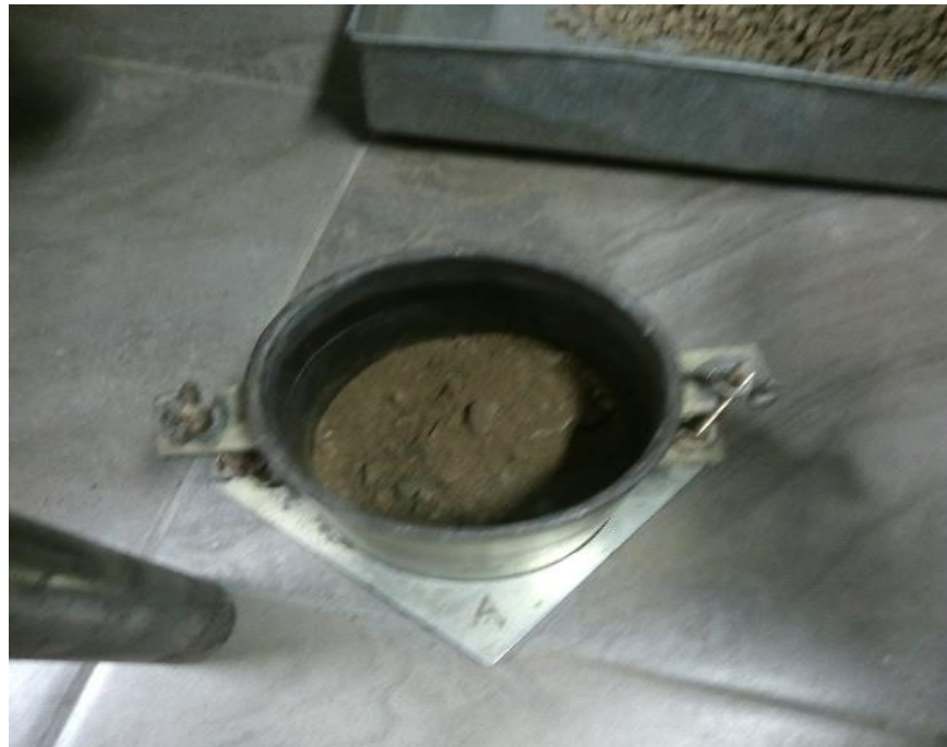
Figura 50. Primera capa vertida en molde de 6" lista para compactar.
