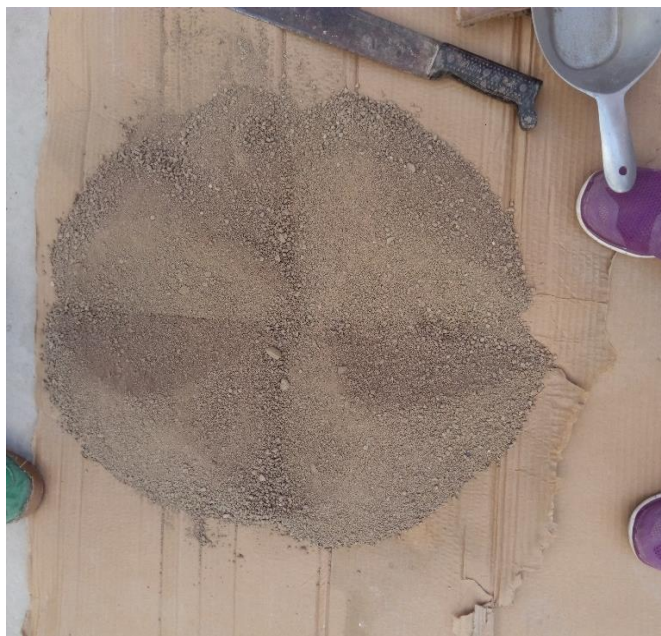
Figura 34. Cuarteo de la muestra de la cantidad de 20 kg.
