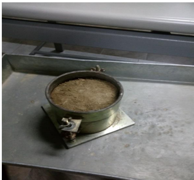
Figura 54. Tanda compactada en 5 capas.
