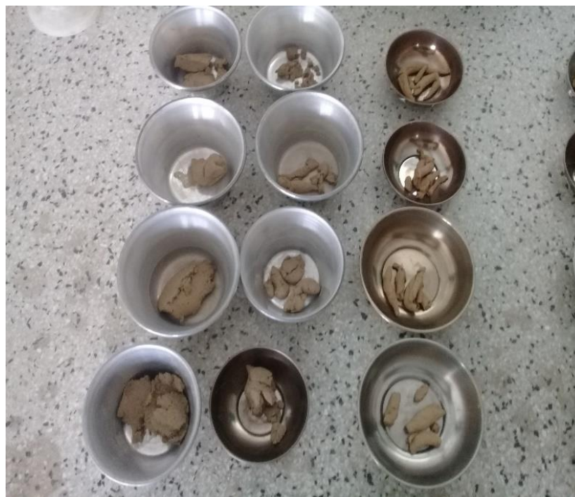
Figura 62. Muestras secas al horno por 24 horas.
