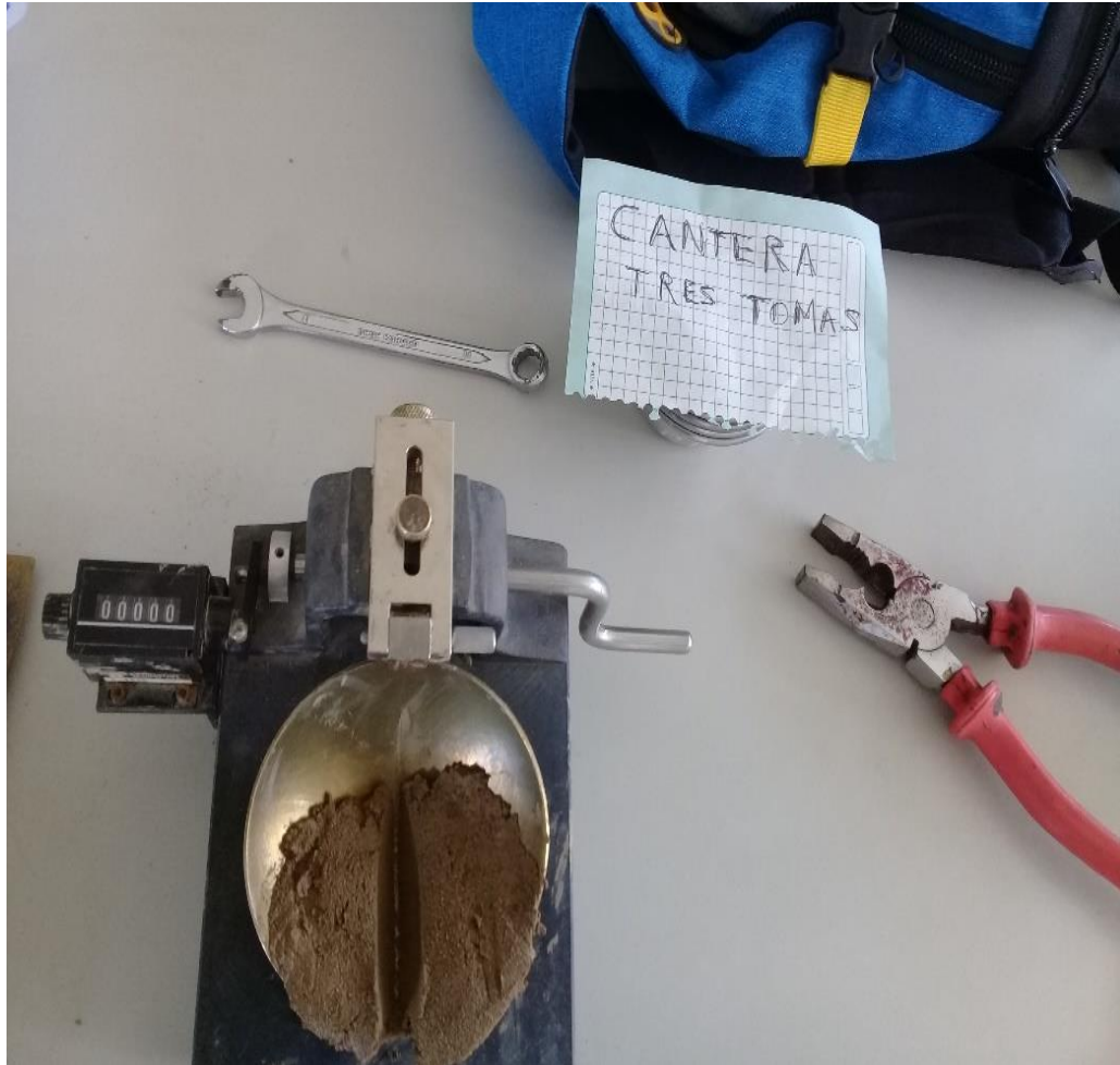
Figura 60. Muestra surcada por el acanalador.
