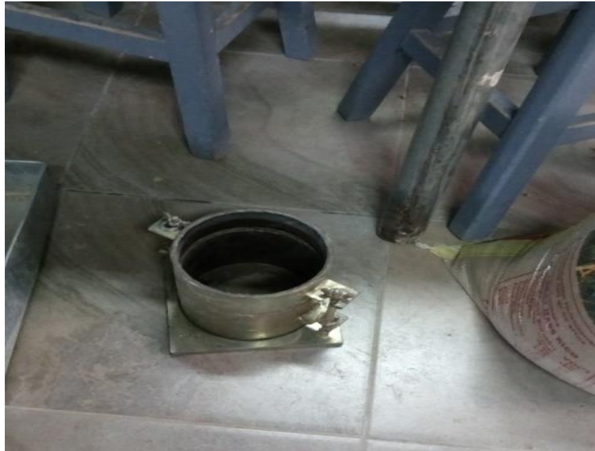
Figura 49. Molde de 6" lista a recepcionar primera capa de muestra.
