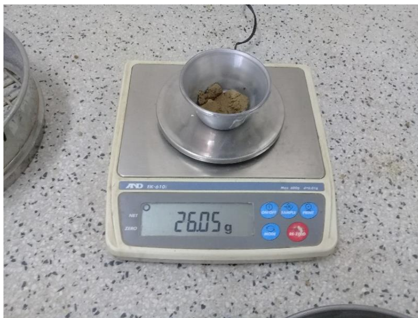
Figura 61. Peso de muestra húmeda.
