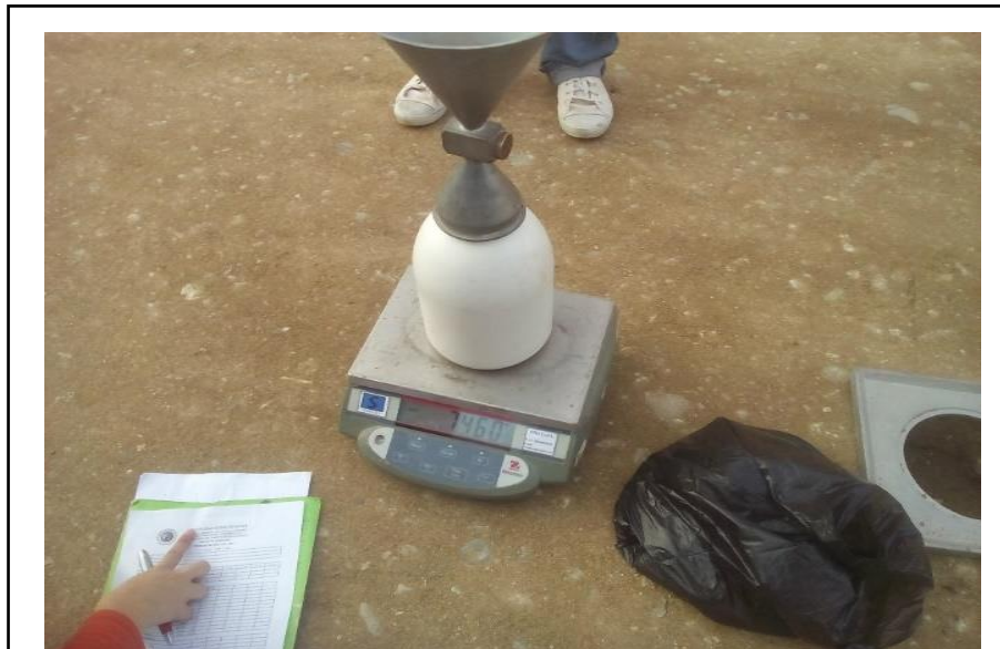
Figura 80. Calibración del cono sin arena – Zona 1.
