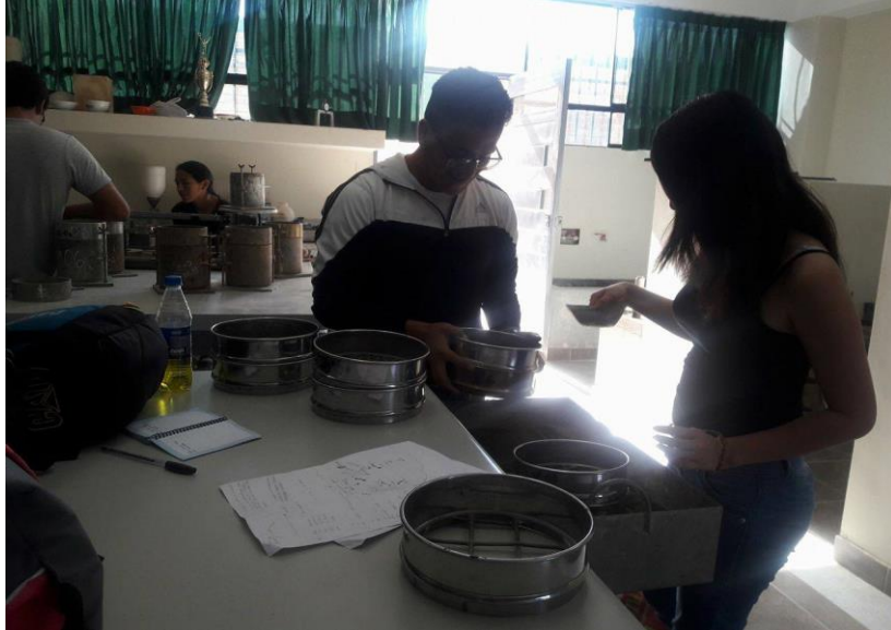
Figura 43. Preparación y tamizado de muestra afirmado de Tres Tomas.
