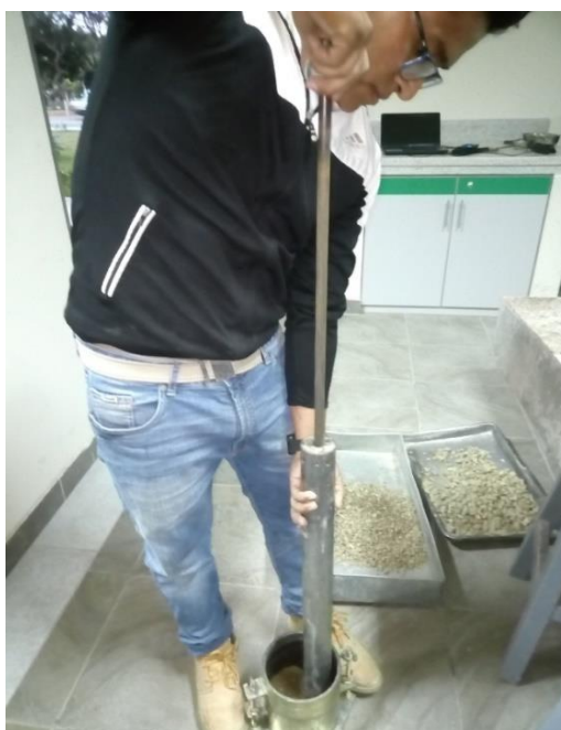
Figura 51. Compactación de primera capa con pisón de 10 lb.
