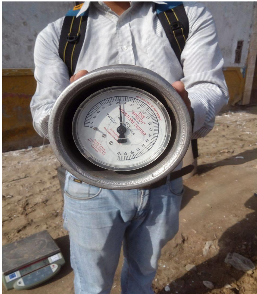
Figura 67. Toma de medida del contenido de humedad en campo del 0% al 20%.
