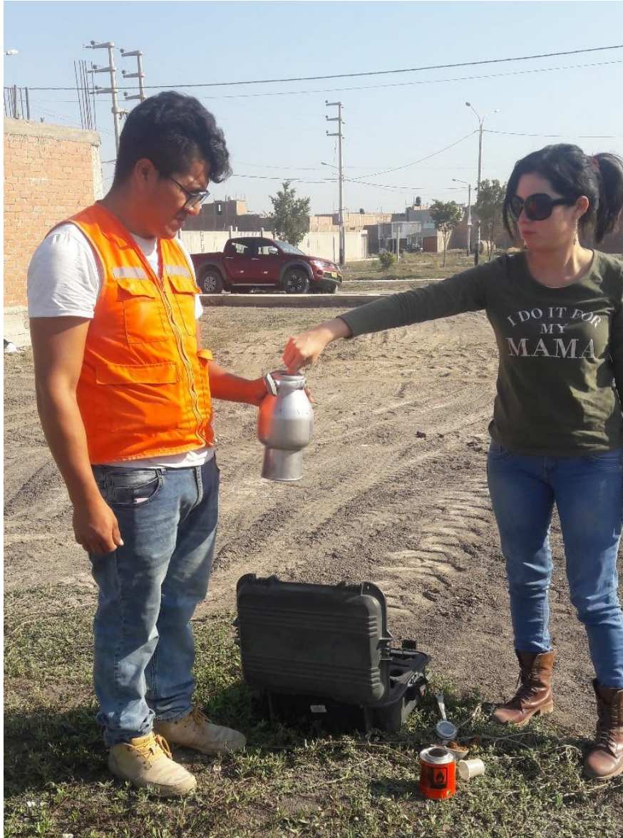
Figura 78. Speedy calculando el contenido de humedad.
