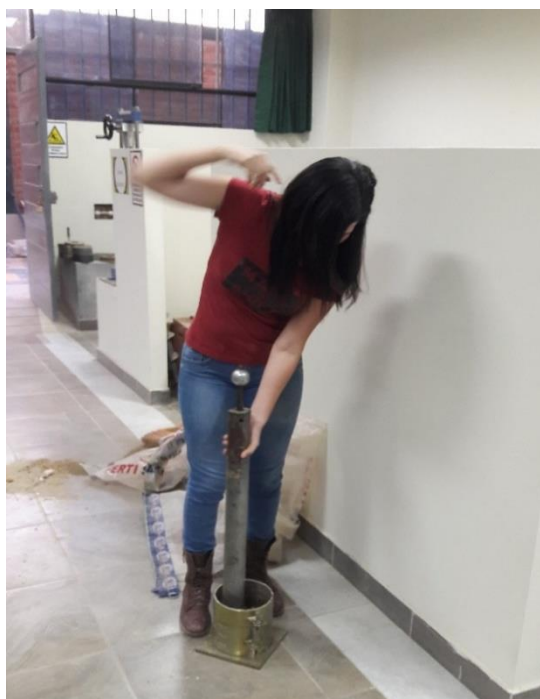
Figura 52. Compactación de segunda capa con pisón de 10 lb.
