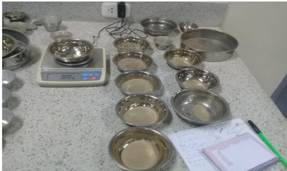
Figura 41. Registro de los pesos del material tamizado por las mallas N°8 hasta la N°200.
