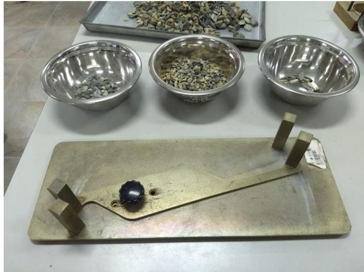
**Figura 18.** Calibrador de partículas chatas y alargadas.
