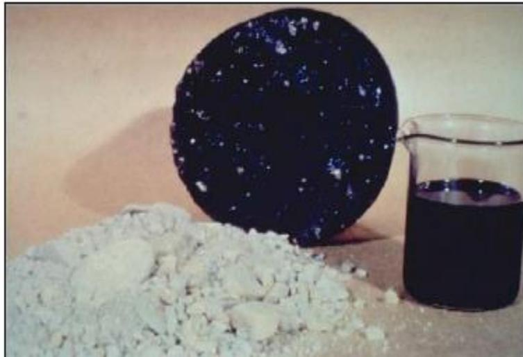
**Figura 3.** Cemento asfáltico, agregados y briqueta - Diseño Moderno de Pavimentos Asfálticos – S. Minaya y Ordoñez H.
