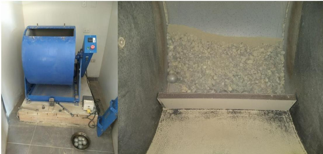
**Figura 17.** Ensayo de abrasión en la máquina de los ángeles.
