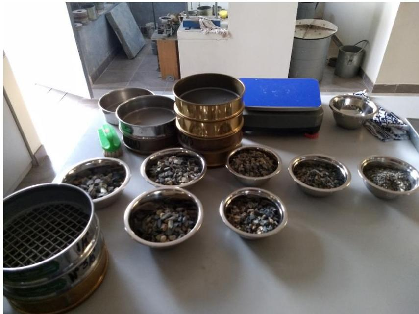
*Figura 15:* Tamizado de los agregados.
