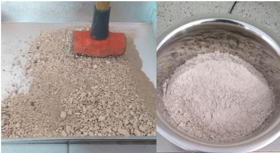
**Figura 23.** Zeolita como agregado y como filler.
