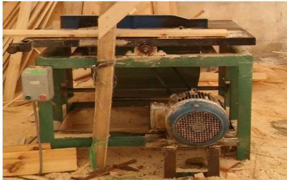
**Figura 23: Máquina Canteadora**
