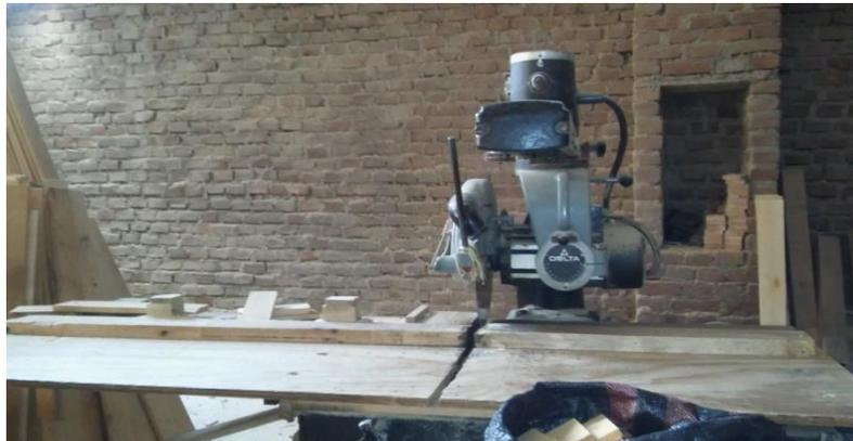
**Figura 22:** Máquina despuntadora horizontal
