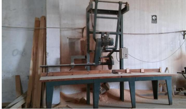
**Figura 21:** Máquina despuntadora vertical 2
