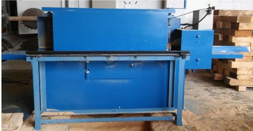
**Figura 19:** Máquina multilamina
