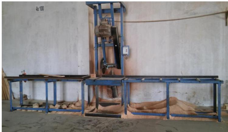
**Figura 20:** Máquina despuntadora vertical 1
