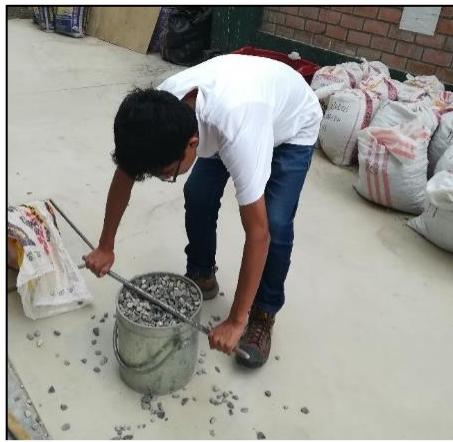
Figura N° 29: Enrasado del agregado grueso.
