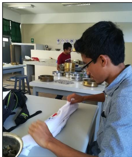
Figura N° 25: Agregado grueso superficialmente seco.
