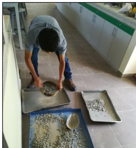
Figura N° 54: Tamizado por la malla N° 12.
