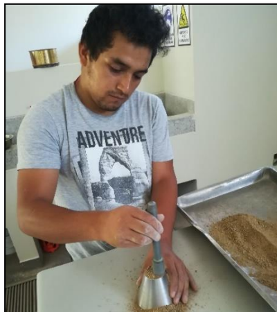
Figura N° 31: Prueba de molde cónico
