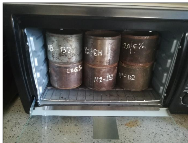
Figura N° 78: Curado de las briquetas al horno
