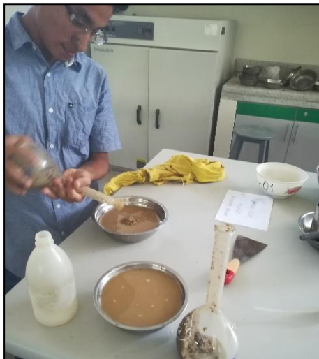
Figura N° 38: Vaciando la muestra en un recipiente en un recipiente
