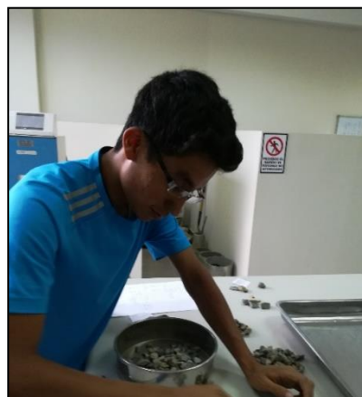
Figura N° 43: Selección de partículas fracturadas.
