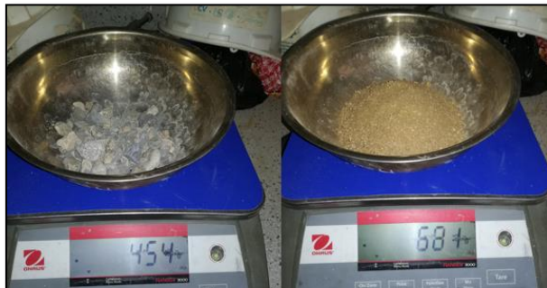
Figura N° 62: Agregado grueso y fino utilizados en el ensayo
