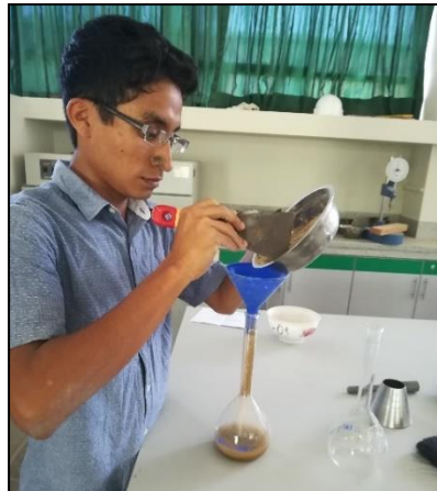
Figura N° 35: Introduciendo muestra a la fiola
