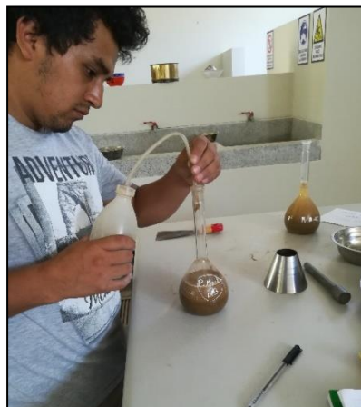
Figura N° 36: Agregando agua a la fiola
