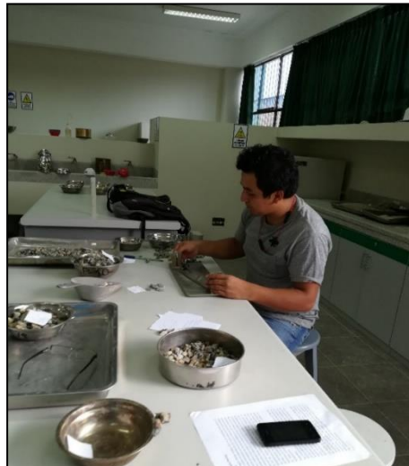
Figura N° 41: Determinación de partículas chatas y alargadas.
