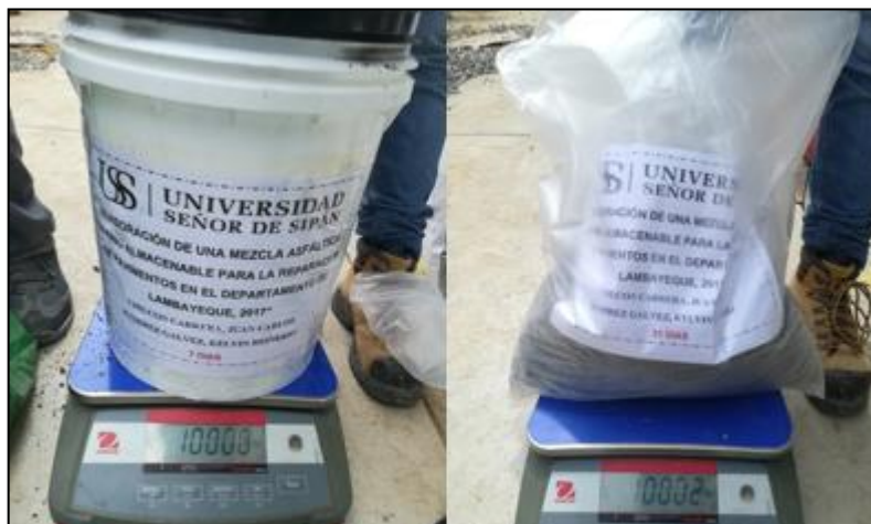
Figura N° 87: Pesaje periódicamente de la muestra almacenada
