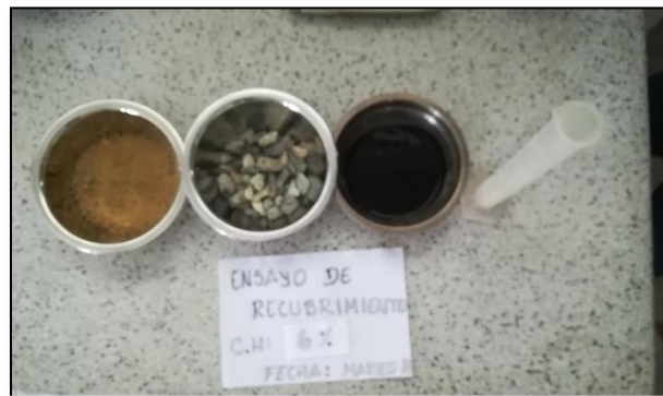
Figura N° 60: Materiales utilizados en el ensayo de recubrimiento
