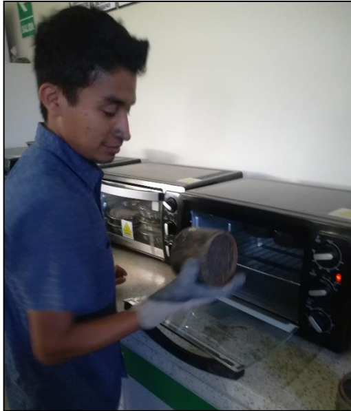
Figura N° 79: Retirando briquetas del horno a 60°C de temperatura
