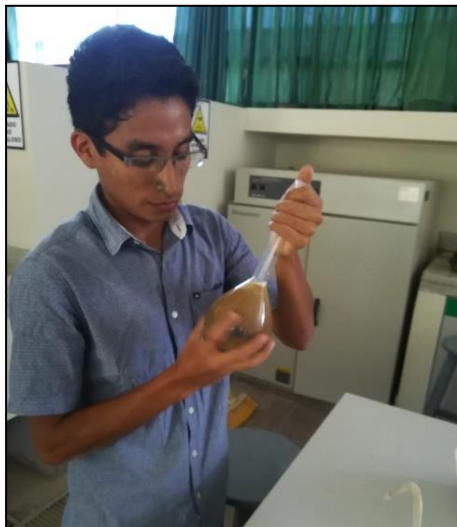
Figura N° 37: Agitando la fiola para eliminar aire retenido
