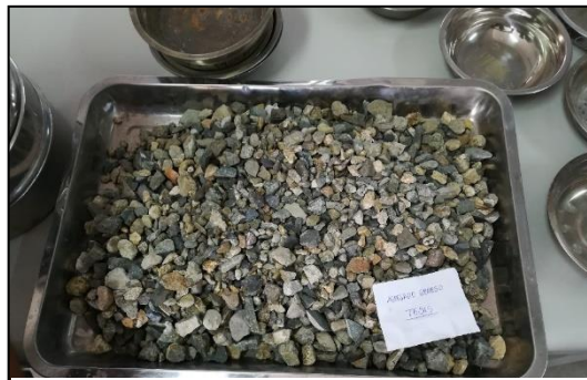
Figura N° 16: Lavado del agregado grueso por el tamiz # 200.
