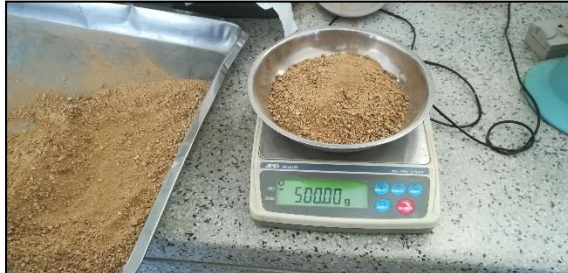
Figura N° 34: Peso de la muestra a ensayar
