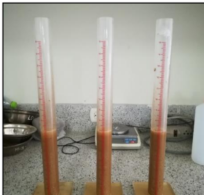
Figura N° 47: Introduciendo muestra en la probeta
