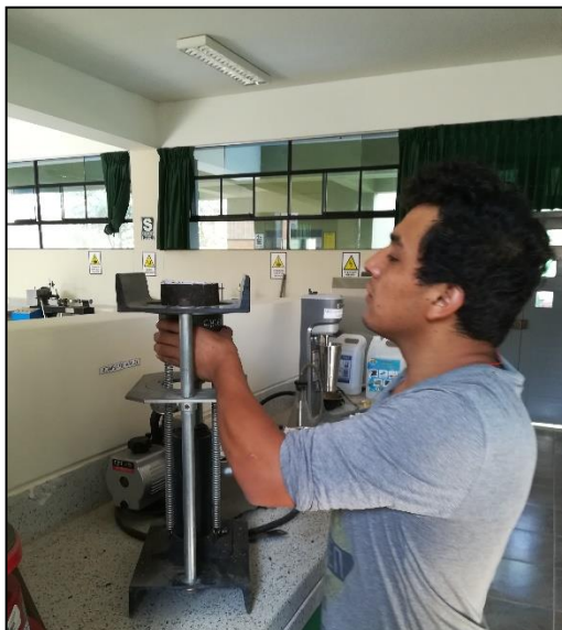
Figura N° 80: Retirando el espécimen de los moldes utilizando la presa hidráulica
