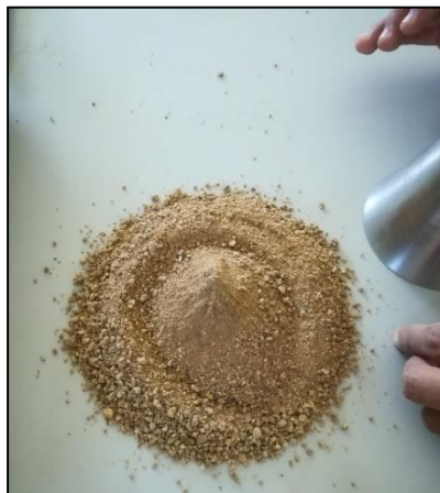
Figura N° 33: Agregado fino saturado superficialmente seco
