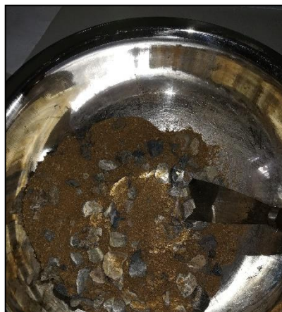
Figura N° 63: Mesclado de los agregados
