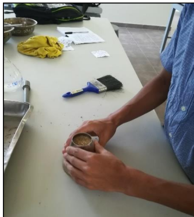
Figura N° 32: Prueba de molde cónico
