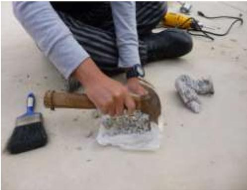
**Figura 128.** Triturando el concreto con ayuda de un martillo.
