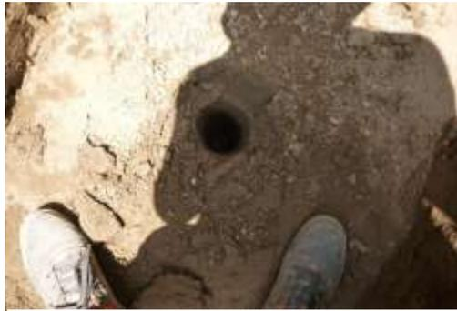
***Figura 56.*** Perforación con la posteadora manual calicata Nº3.
