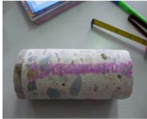
**Figura 120.** Núcleo de concreto con fenolftaleína.
