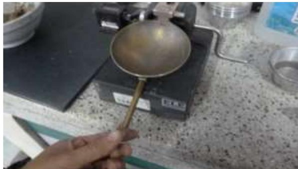
**Figura 89.** Calibración de equipo de copa casagrande.
