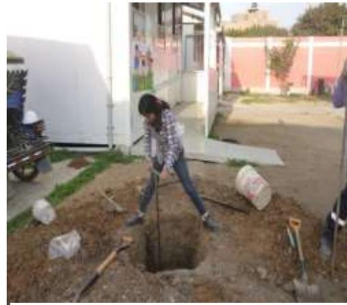
***Figura 50.*** Utilizando la posteadora manual en la calita N° 2.
