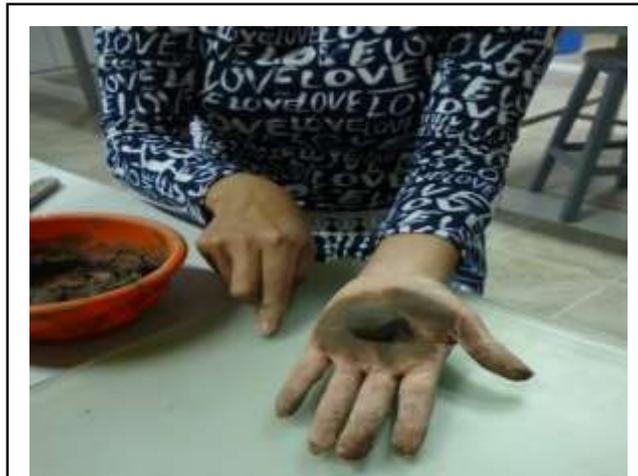
*Figura 95.* Esferas de material de suelo.
