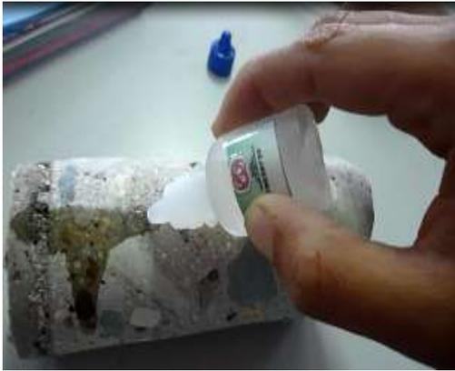
**Figura 121.** Colocando fenolftaleína al núcleo de concreto.
