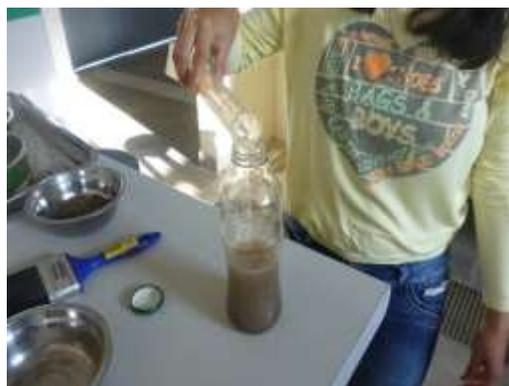
**Figura 101.** Agregando los 250ml de agua destilada al frasco.
