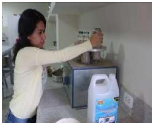
**Figura 103.** Colocamos los frascos en la agitadora mecánica por una hora.
