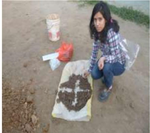
***Figura 53.*** Realizando el cuarteo del material antes de ser almacenado.
