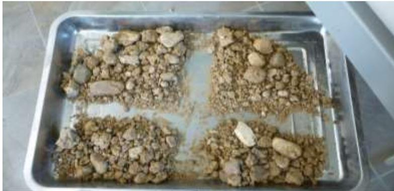
**Figura 76.** Realizando el cuarteo de las muestras de suelo con agregado grueso.
