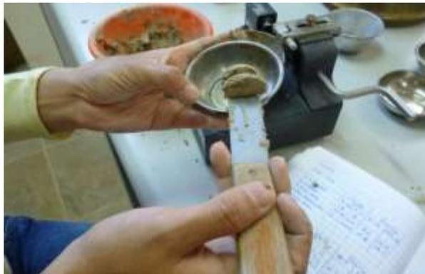
**Figura 93.** Retiramos el material del corte transversal.
