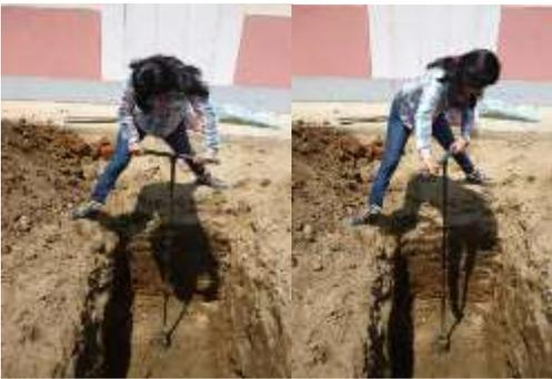
***Figura 57.*** Utilizando la posteadora manual.
