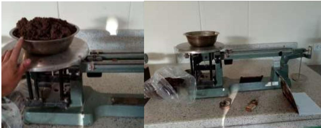
**Figura 74.** Realizando el pesado correspondiente de las muestras de suelo por cada estrato.
