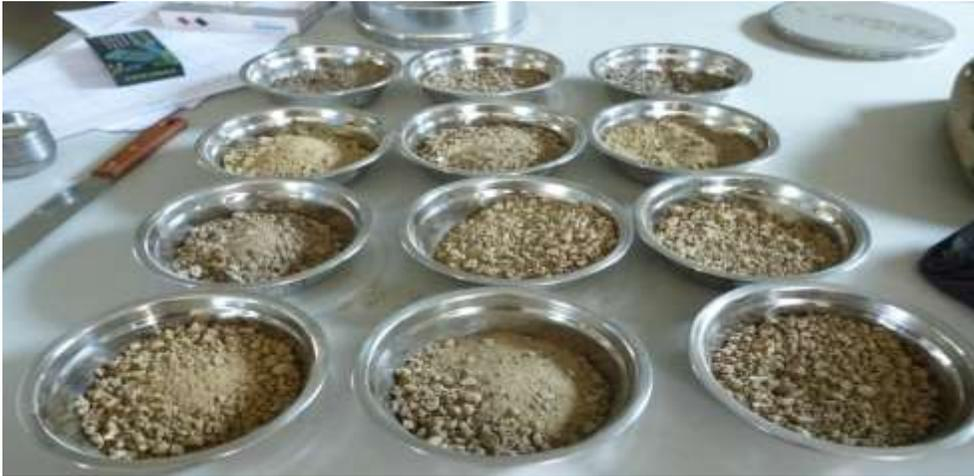
**Figura 79.** Muestras de suelos de los diferentes estratos por calicatas debidamente pesadas.
