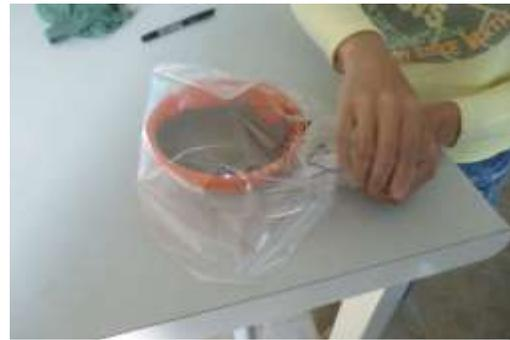
**Figura 87.** Guardando el material con una bolsa plástica y dejar reposar 24 horas.
