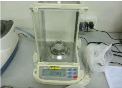
**Figura 131.** Pesando el polvillo de concreto en una balanza electrónica.
