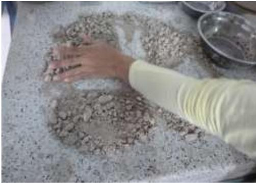
**Figura 83.** Realizando el cuarteo de material retirado del horno.
