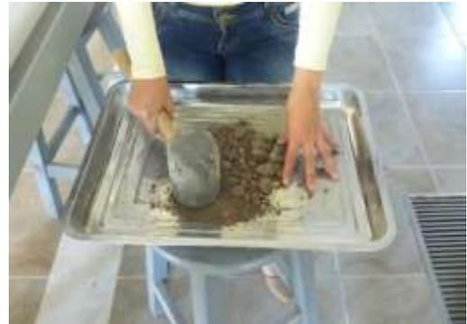
**Figura 84.** Realizando la trituration del material con un matillo de goma.
