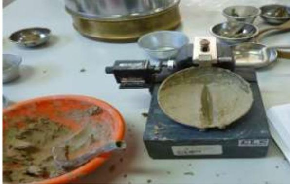
**Figura 92.** Se observa el cierre del corte trasversal del material.
