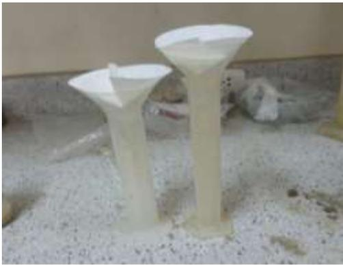
**Figura 106.** Doblamos el papel filtro con sumo cuidado y colocamos en el embudo.
