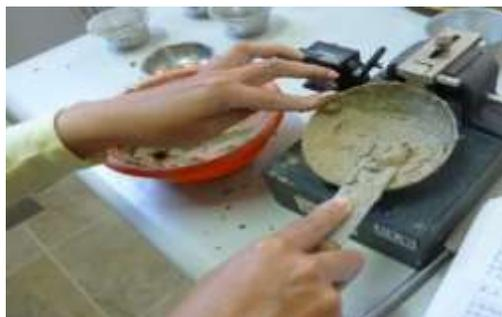
**Figura 90.** Agregando material con una espátula a la copa Casagrande.
