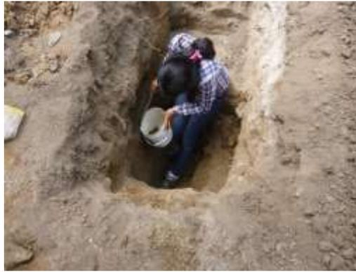
**Figura 61.** Recolectando el material de los estratos de la calicata Nº1
