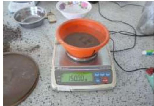
**Figura 85.** Realizando el pesado de la muestra pasada por el tamiz N°10.
