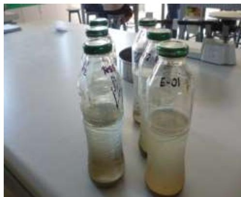
**Figura 104.** Dejar reposar los frascos por 24 horas o hasta que el agua se aclare.
