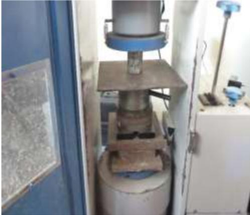
*Figura 126.* Colocando el núcleo de concreto en la máquina de resistencia a compresión.
