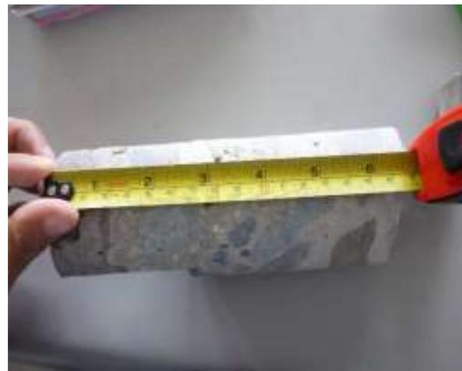
**Figura 118.**tomando medidas del núcleo del concreto.
