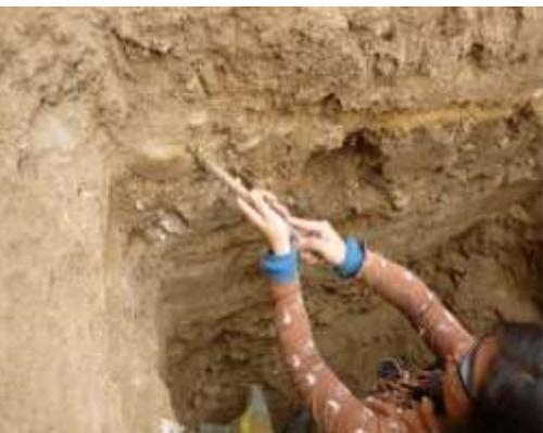
**Figura 70.** Recolectando el material de los estratos de la calicata Nº1.
