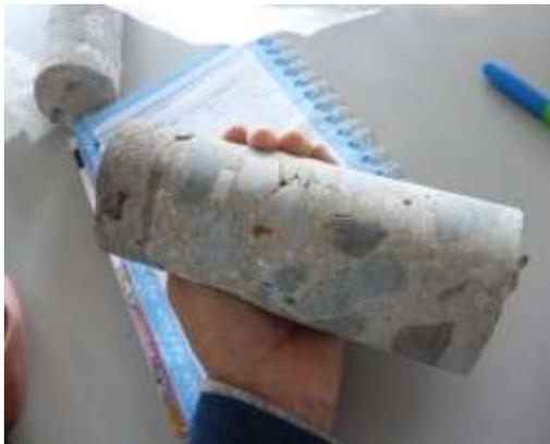
**Figura 119.**Núcleo de concreto extraído limpio.
