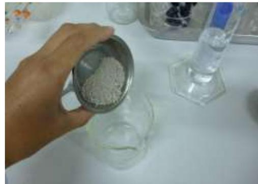
**Figura 130.** Agregando el polvillo de concreto a un vaso graduado.
