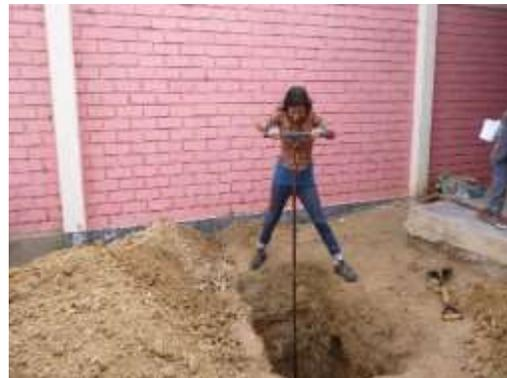
**Figura 69.** Utilizando la posteadora manual calicata Nº1.
