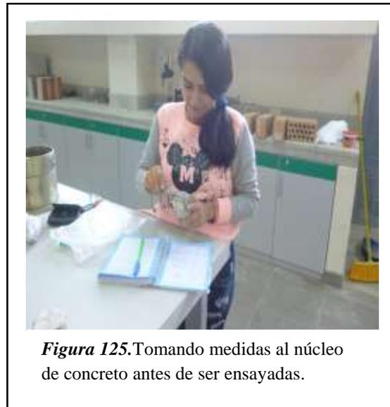
2°. Los núcleos o testigos serán ensayados a compresión después de 48 horas o antes de 7 días de su extracción, se colocan a los testigos a la máquina de ensayo a la compresión y se aplica una fuerza uniforme hasta llegar a su ruptura.
