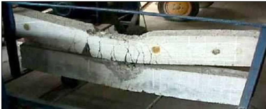
**Figura 13.** Deformación por flecha
