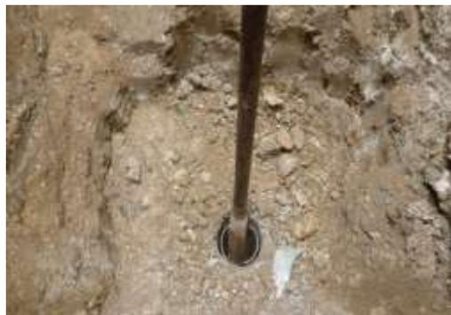
**Figura 64.** Utilizando la posteadora manual calicata Nº3.
