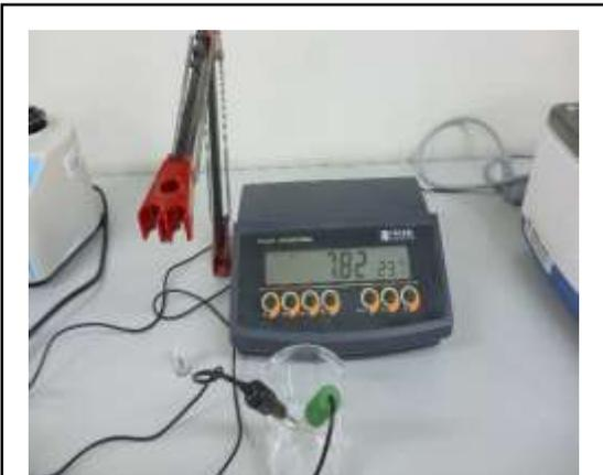
**Figura 134.** Calibración de equipo de medidor de pH.
