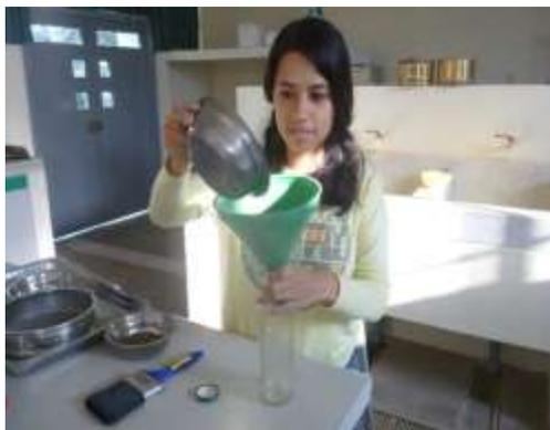
**Figura 100.** Agregando el material al frasco con ayuda de un embudo.
