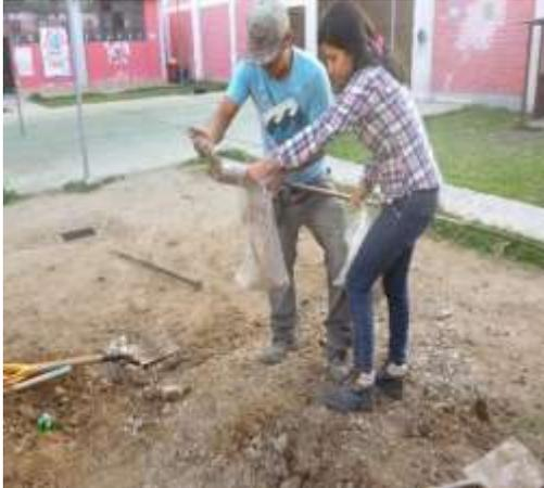
***Figura 52.*** Recolectando material de la posteadora manual.
