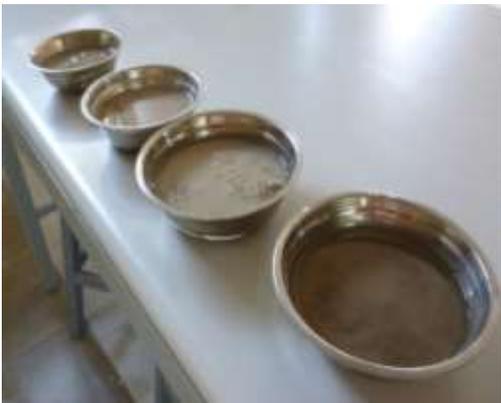
**Figura 80.** Saturado de muestras de suelos por estrato.
