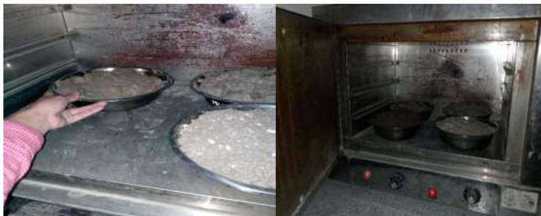
**Figura 75.** Colocando las muestras de suelo por cada estrato al horno.
