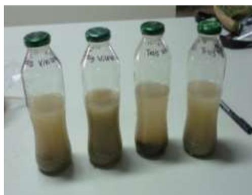
**Figura 102.** Frasco llenos con diferentes estratos por calicata.
