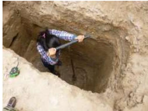
**Figura 63.** Utilizando la posteadora manual calicata Nº2.
