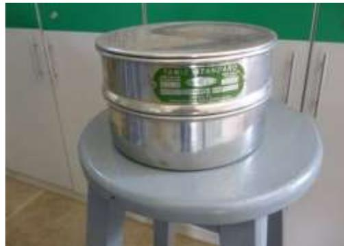
**Figura 86.** Realizando el tamizado de material por el tamiz N°40.
