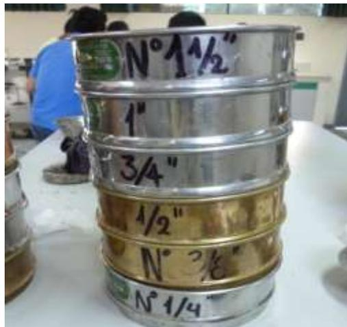
**Figura 78.** Tamices para realizar la granulométrica con material grueso.
