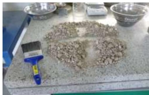
*Figura 73.* Realizando el cuarteo del material.
