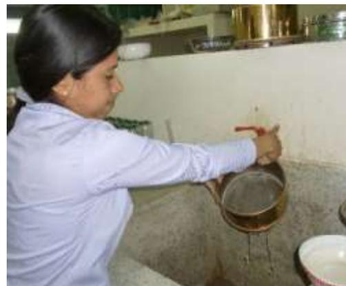
**Figura 81.** Lavado de muestra de suelos con el tamiz N°200.
