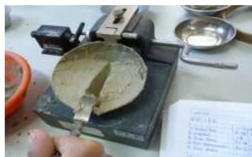
**Figura 91.** Realizando el corte transversal con un ranurador.
