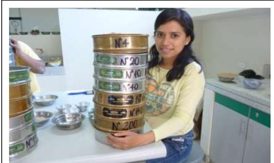
*Figura 82.* Tamizado el material fino por lo diferentes tamices.
