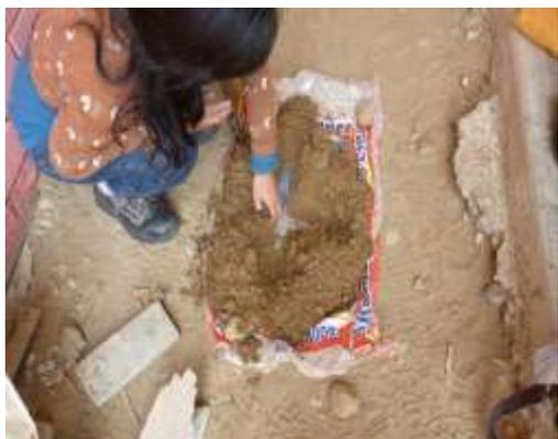
**Figura 71.** Realizando el cuarteo del material antes de ser almacenado.
