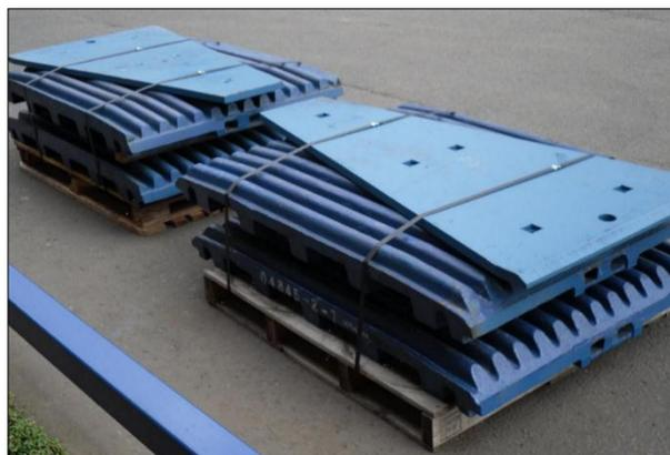
**Figura 3:** Piezas antidesgaste y mandíbula de una trituradora
