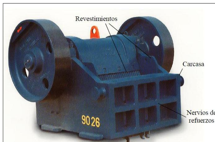
**Figura 8:** Trituradora de simple efecto
