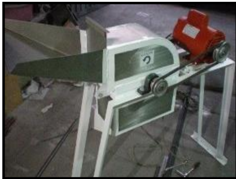
Figura 74. Molino de martillos de 250 kg/h Fuente: ALICONSA, 2017
