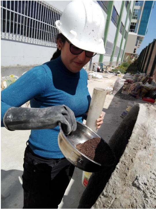
Figura 27: Diseño de mezclas con limaduras de acero
