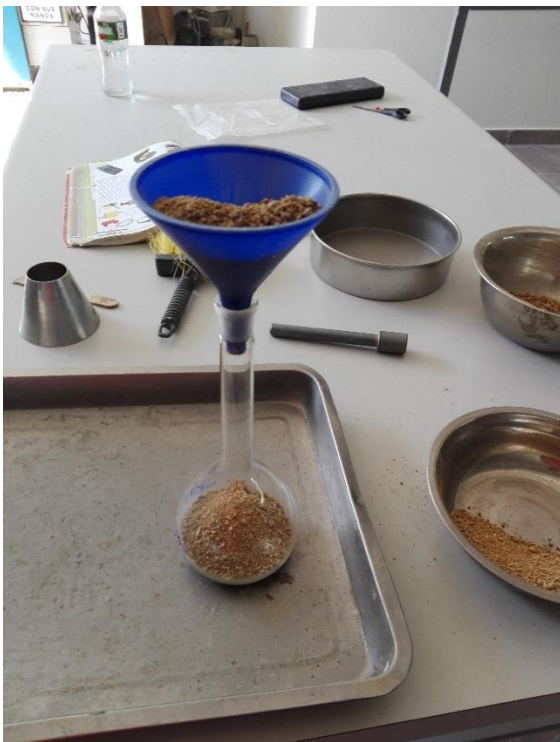
Figura 24: Ensayo porcentaje de absorción del agregado fino
