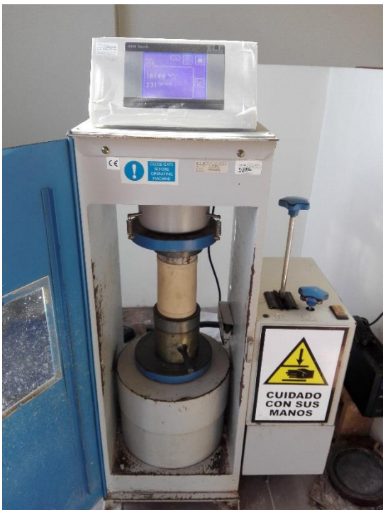
Figura 32: Resistencia a la compresión
