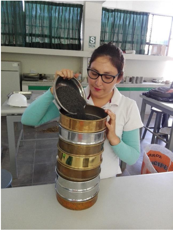
Figura 23: Análisis granulométrico de las limaduras de acero
