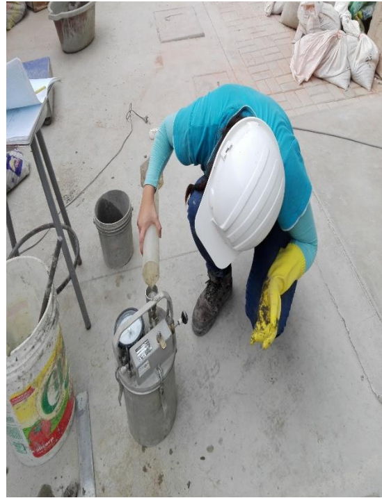
Figura 29: Contenido de aire del concreto
