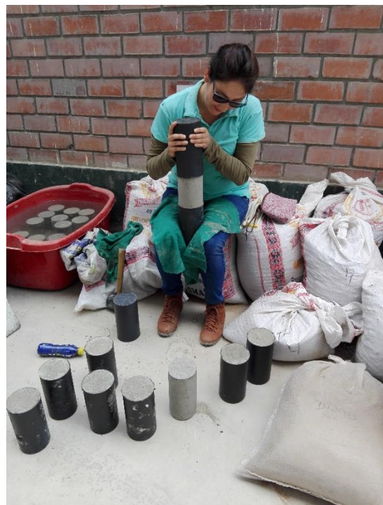
Figura 30: Extracción de las probetas
