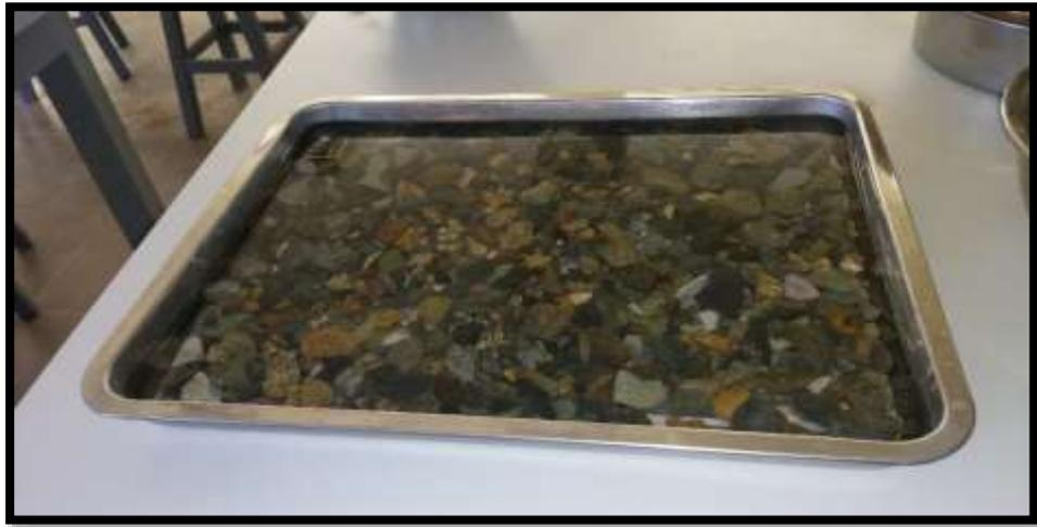
*Figura 24.* Muestra del agregado gruesa saturada por 24h
