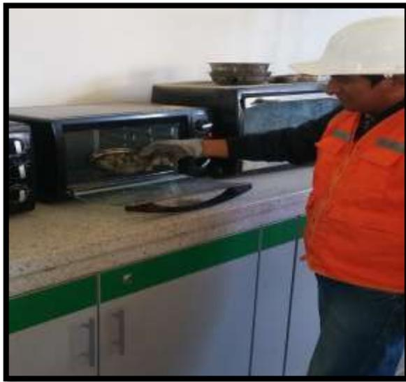
Figura 29. Muestra del agregado grueso secada al horno por 24h.
