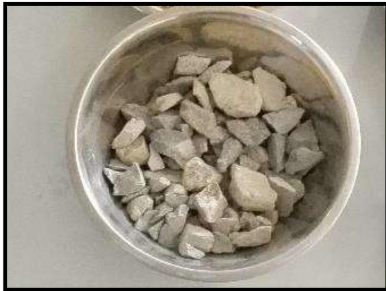
*Figura 27.*Muestra seca el agregado grueso después de 24h de colocado en el horno.
