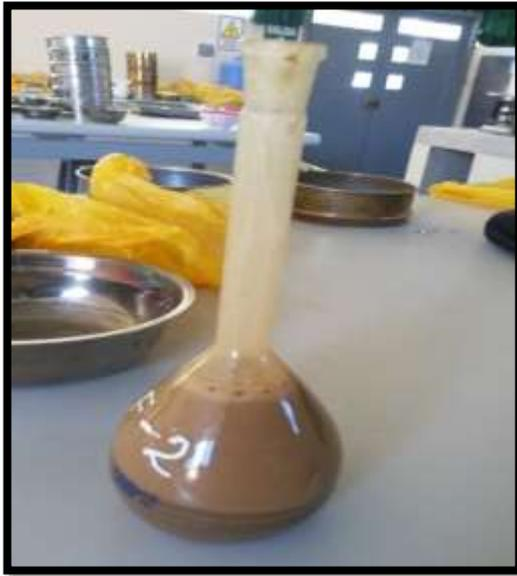
*Figura 22.* Volumen del agregado fino por el método gravimétrico.
