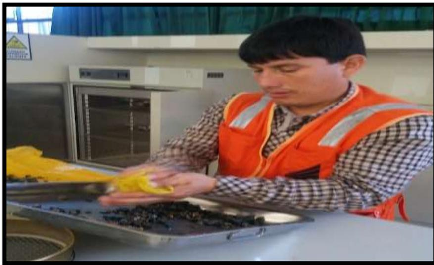
*Figura 25.* Secado del agua de la superficie de las partículas del agregado grueso
