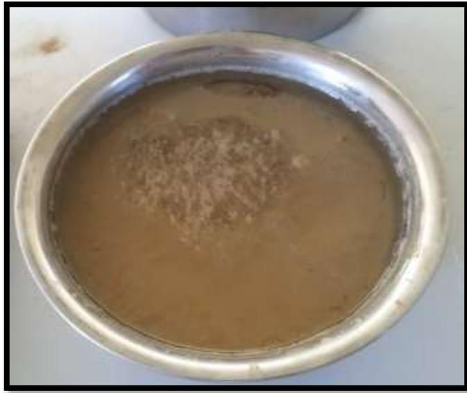
*Figura 20.*Muestra del agregado fino saturada por 24h.
