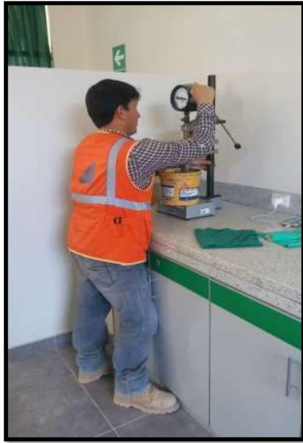
*Figura 37.*Ensayo del tiempo de fraguado con el equipo del Penetrómetro.
