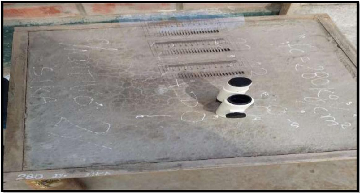
Figura 41. Fisurómetro y regla de fisuras para el control de la fisuración.
