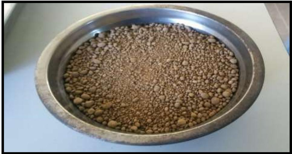
*Figura 23.* Muestra seca del agregado fino después de 24h de colocado en el horno.
