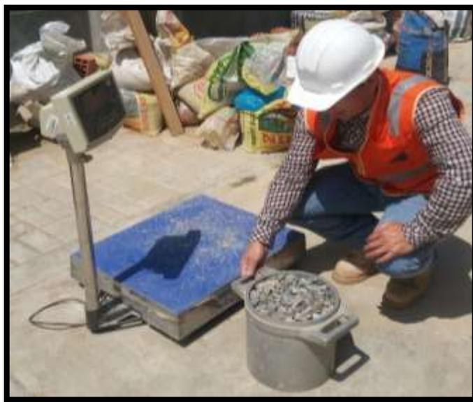
Figura 19. Molde con agregado grueso para obtención del Peso unitario.
