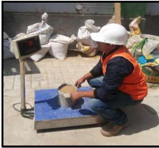
*Figura 18. Molde con agregado fino para obtención del Peso unitario.*
