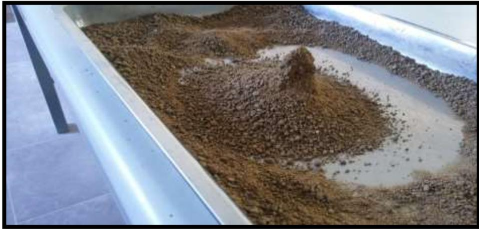
*Figura 21.*Muestra del agregado fino saturada superficialmente seca.
