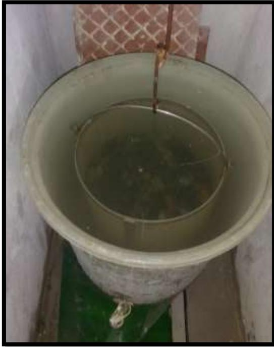
*Figura 26.*Muestra del agregado grueso en canastilla sumergida en agua.
