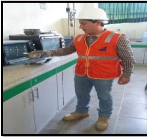
*Figura 28. Muestra del agregado fino secada al horno por 24h.*
