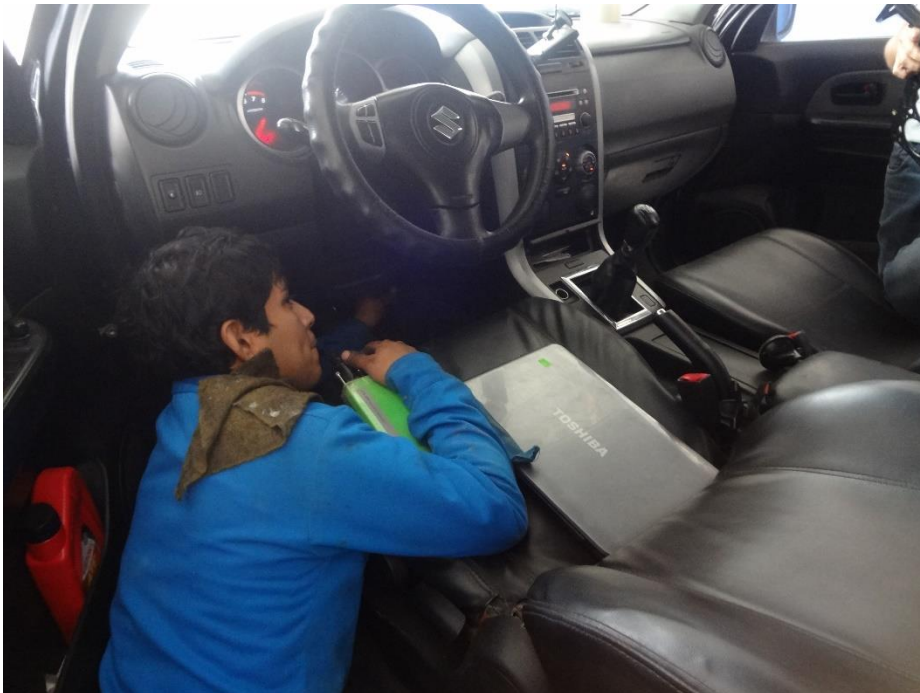
Foto 2: Conexión del Scanner Bosch KTS 570 al módulo del vehículo
