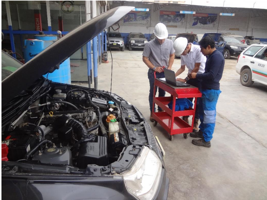
Foto 5: Toma de datos mediante el Scanner Bosch KTS 570
