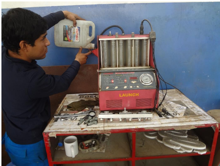
Foto 8: Test de prueba para medición de consumo de inyectores.
