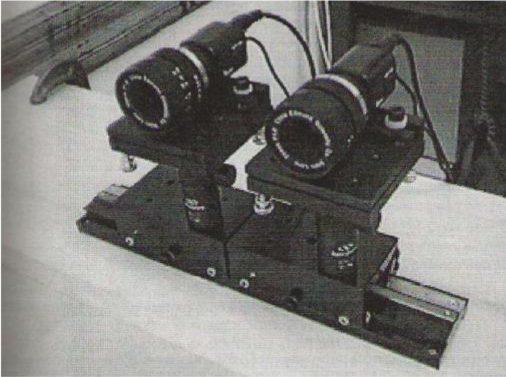
Ilustración 7 Instalación estéreo con dos cámaras idénticas y paralelas
