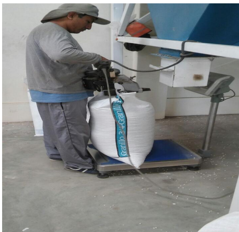
Figura 11: Trabajador sin guantes ni zapatos adecuados.
