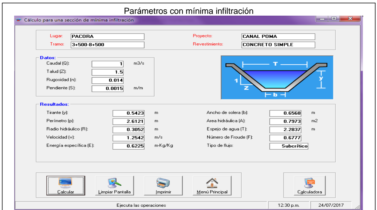
Figura 23. Parámetros con mínima infiltración de un canal en el software Hcanales.
