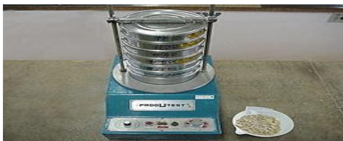
Figura 8. Columna de tamices de diferentes medidas sobre la máquina de ensayo. Adaptado de Civilgeeks.com
