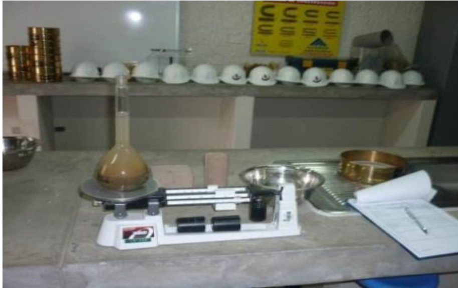
Figura 9 . Ensayo para determinar el peso específico.
