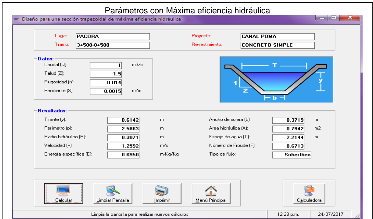
Figura 22. Parámetros con Máxima eficiencia Hidráulica de un canal en el software Hcanales.
