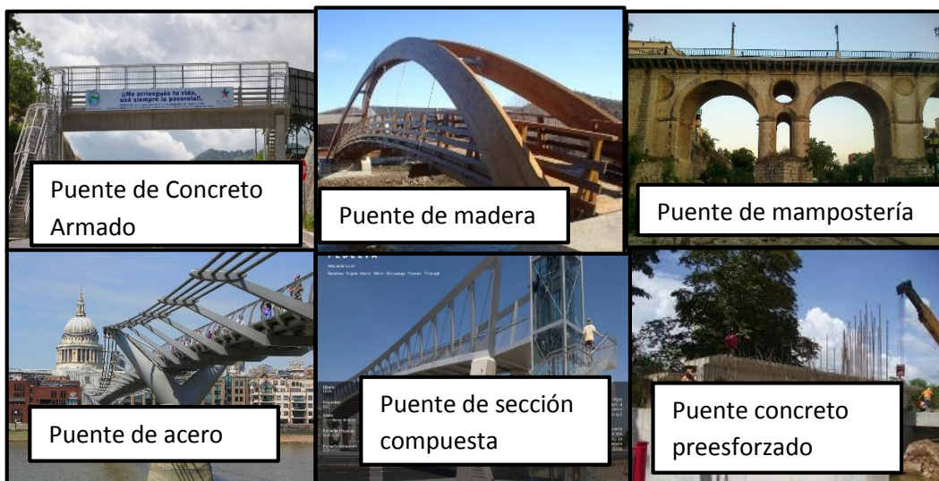
Ilustración 6: Puentes según el material de construcción.
