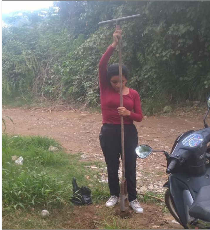
Figura 19. Inicio de perforación en suelo
