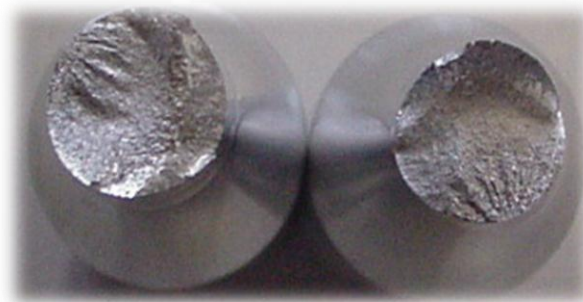
Figura 14: Superficie de ruptura por fatiga.
