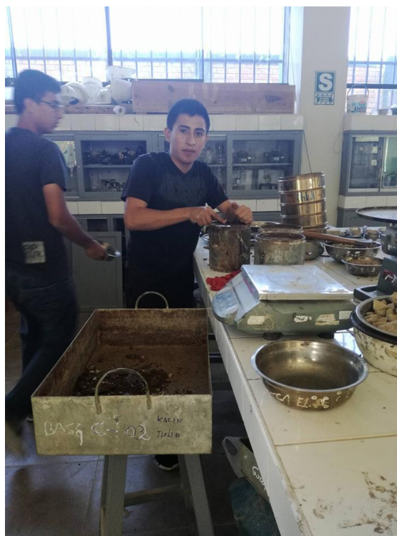
Figura 20 Desparafinando las muestras inalteradas del molde CBR
