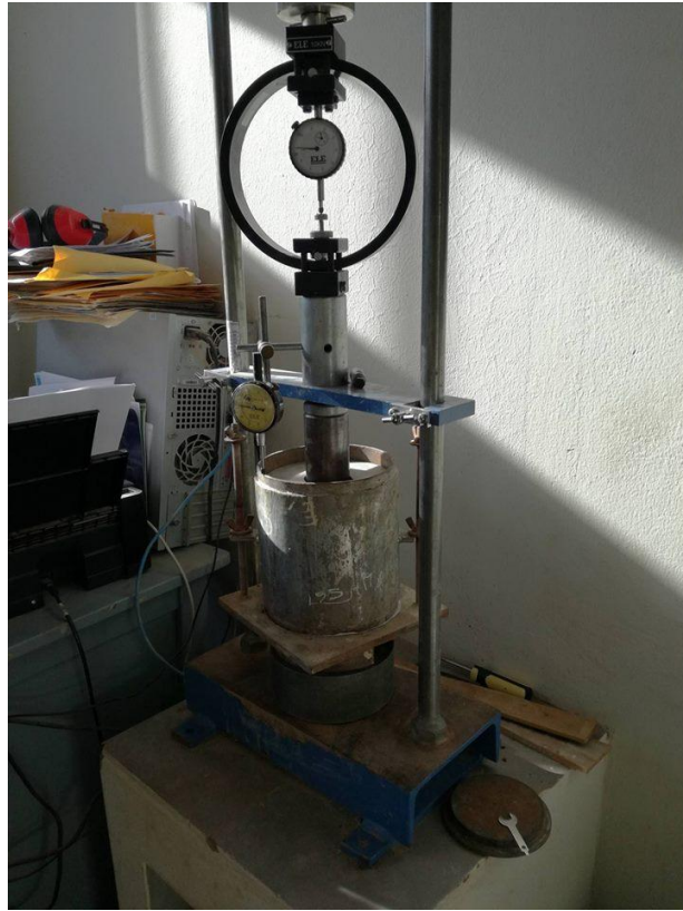
Figura 22 Maquina montada con el molde CBR para realizar el ensayo de penetración.
