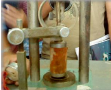
Figura 29 Ensayo de compresión inconfiada
