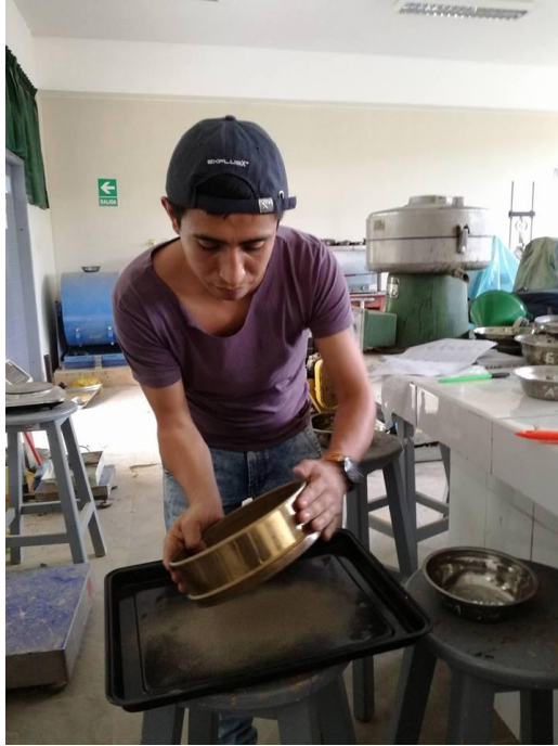
Figura 16 Tamizado de las muestras de suelos alteradas
