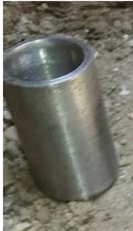
Figura 26 Tubo para extracción de muestras inalteradas para Compresión Inconfinada
