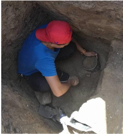
Figura 14 Extracción de muestras inalteradas
