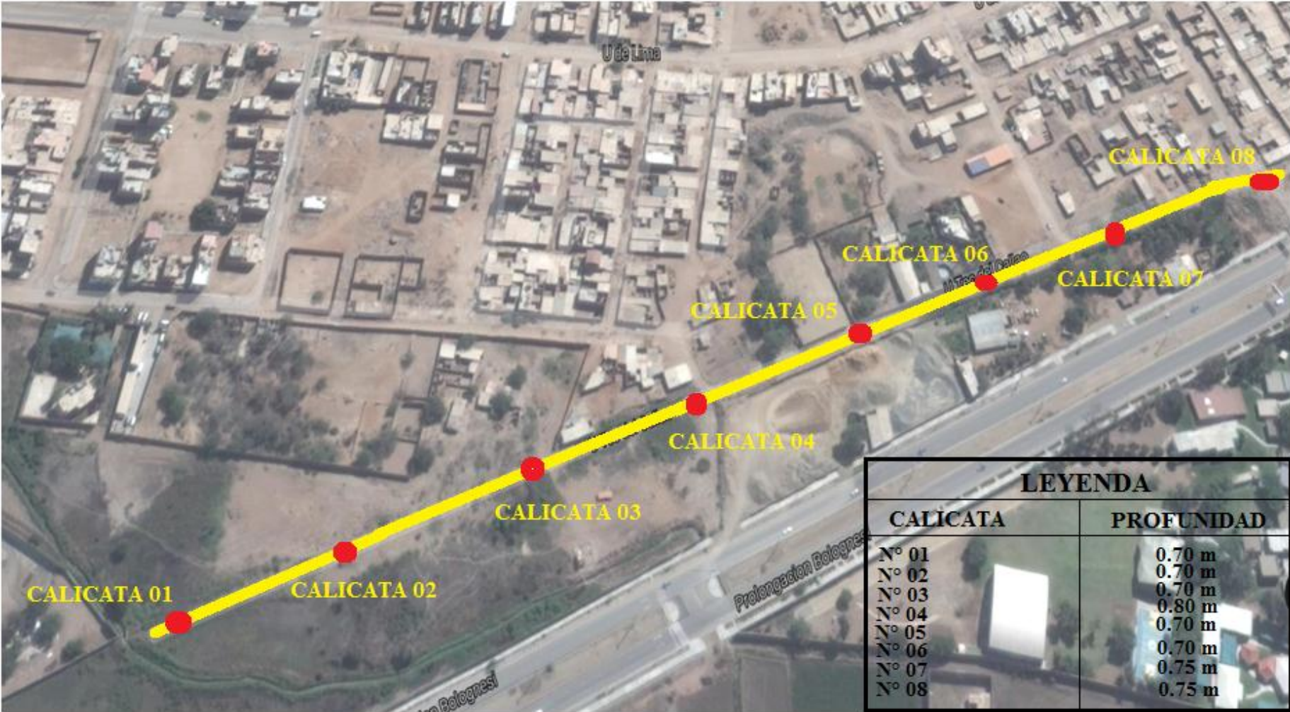
Plano de ubicación de las calicatas en estudio – en Av. Universidad tec. Del Callao
