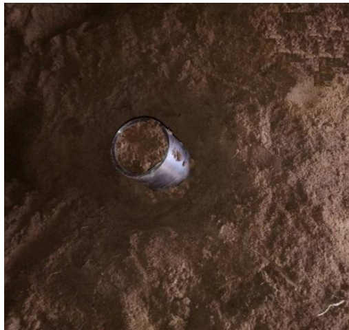
Figura 15 Extracción de muestras inalteradas con tubo de acero inoxidable
