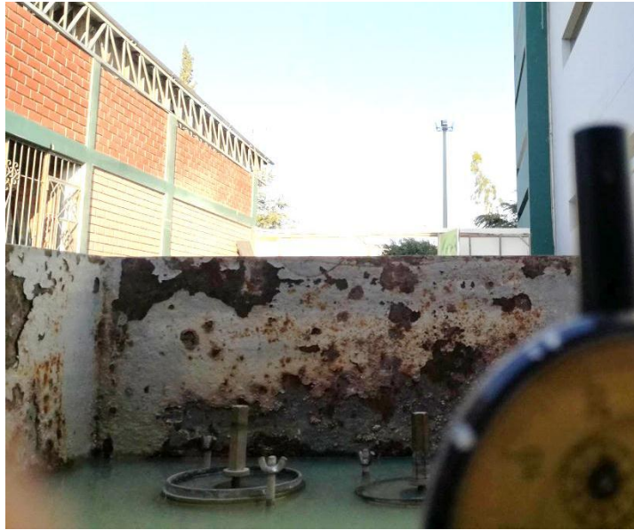
Figura 23 Inmersión de las muestras en los moldes de CBR
