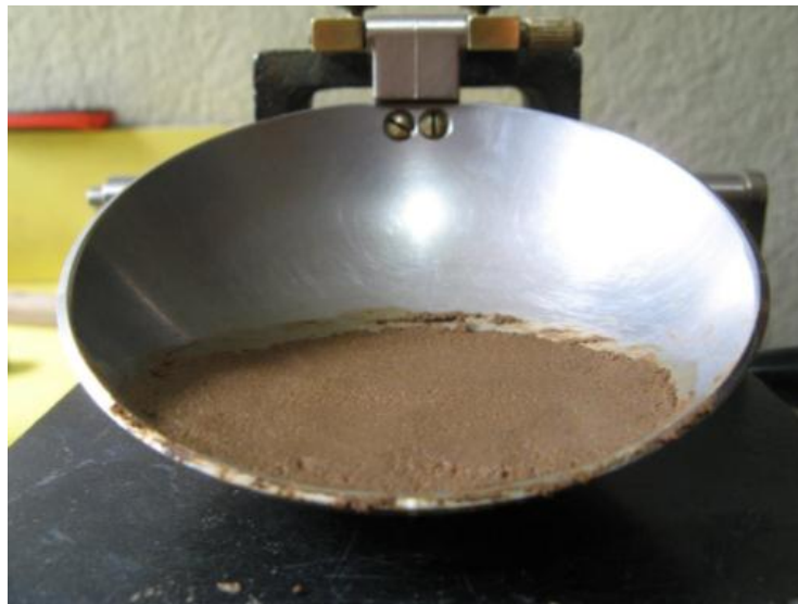
Figura 19 Ensayo de Copa Casa Grande para el límite líquido
