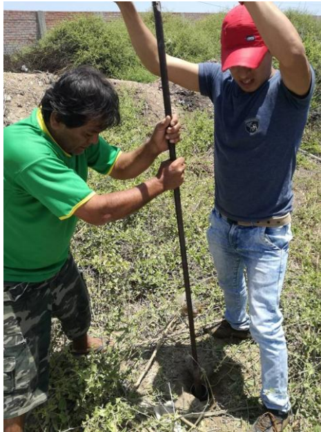
Figura 11 Extracción de muestras alteradas con posteadora
