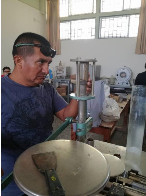
Figura 27 Extracción de muestras inalteradas para ensayo de Compresión inconfiada
