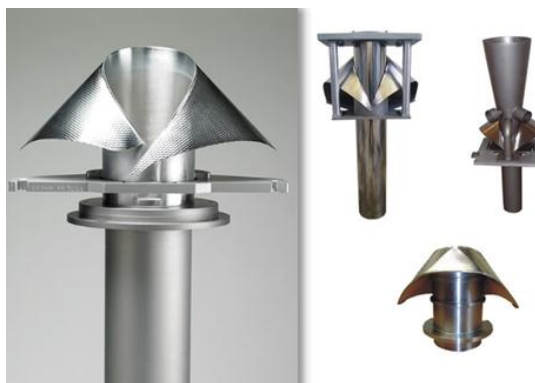
Figura 21: Formadores de fundas circulares y rectangulares.
