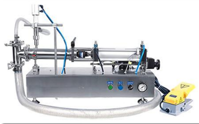
Φιγυρα 17: Dosificación Volumétrica por pistón neumático.
