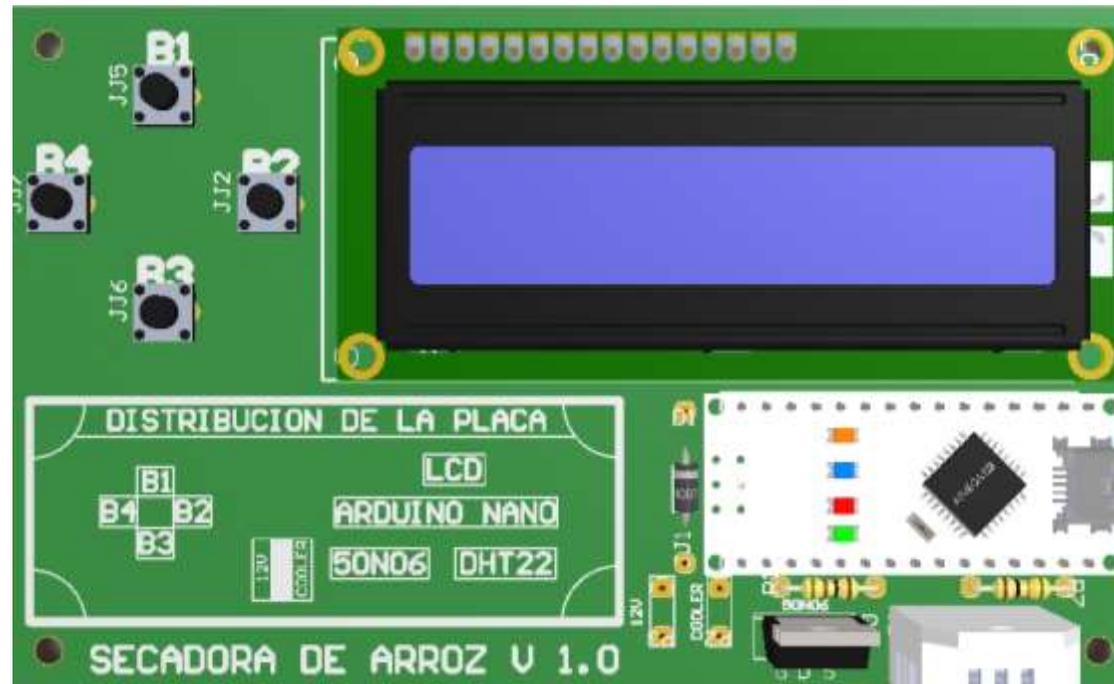
*Ilustración 71:* Vista frontal de la tarjeta de Arduino con los sensores de temperatura y humedad. Fuente: Propia.
