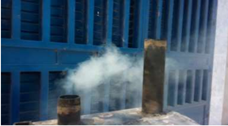
Figura 4.2: Emisión de humo Blanco durante la carbonización. Fuente: Elaboración Propia.
