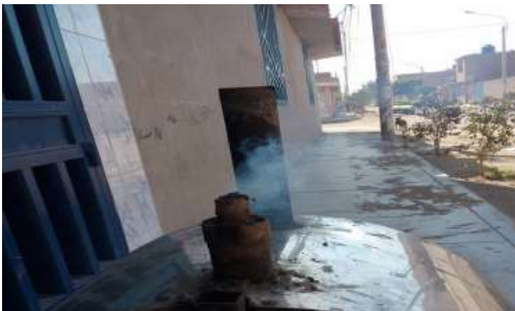
Figura 4.3: Emisión de humo Azul durante la carbonización. Fuente: Elaboración Propia.
