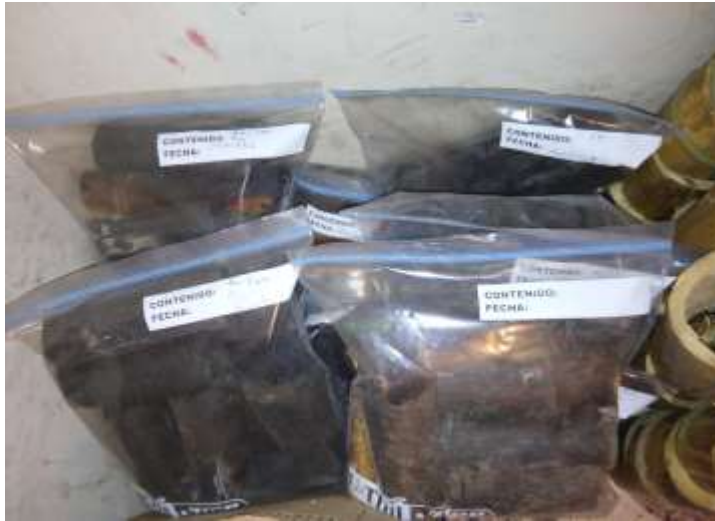
Figura 7.5: muestras de carbón vegetal con cañas maduras. Fuente: Elaboración propia.
