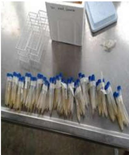
Muestras terminadas después de la hidrolisis enzimática
