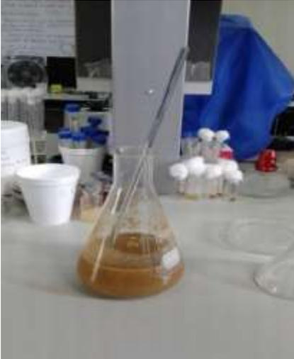
Deslignificación de la harina de cascara de mango con NAOH
