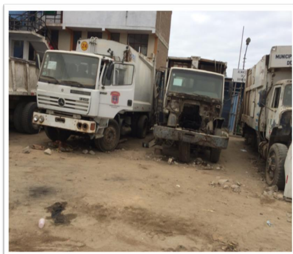
Figura 22: Evidencia de maquinaria paralizada por deterioro y fallas mecánicas encontradas en la planta de la unidad de gestión de residuos sólidos, Chiclayo.
