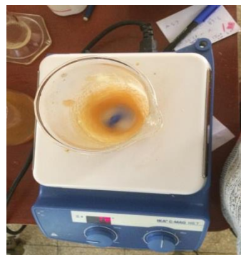
b) Homogenización de la mashua concentrada con los encapsulantes
