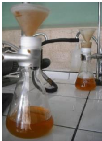
Filtración de las muestras para eliminar los floculos formados luego de la prueba de jarras,
