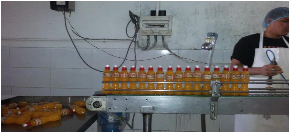
Figura 11: Estación de tapado.
