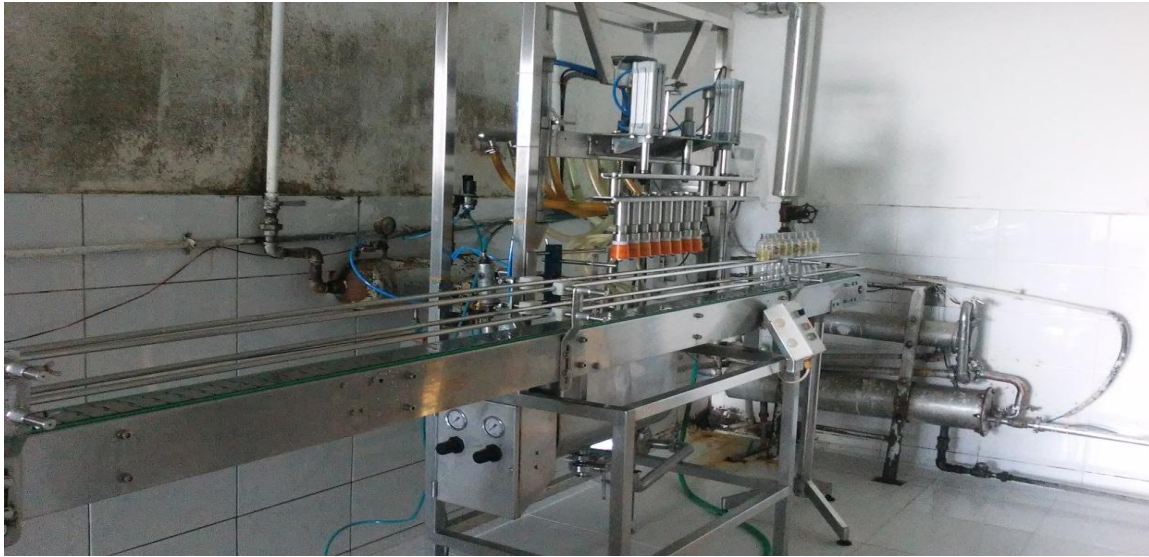
Figura 10: Máquina llenadora e intercambiador de calor.
