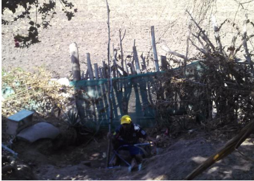
Figura 3: La medición de la presión se hizo con ayuda de uno de los pobladores, en la cual se obtuvo una altura de 1.05 m.c.a.
