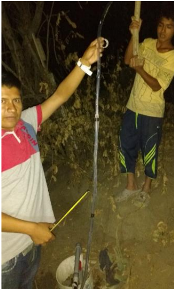
Figura 5: Esta medición se realizó a las 8:00 pm, en la cual se obtuvo una altura de 1.75 m.c.a.
