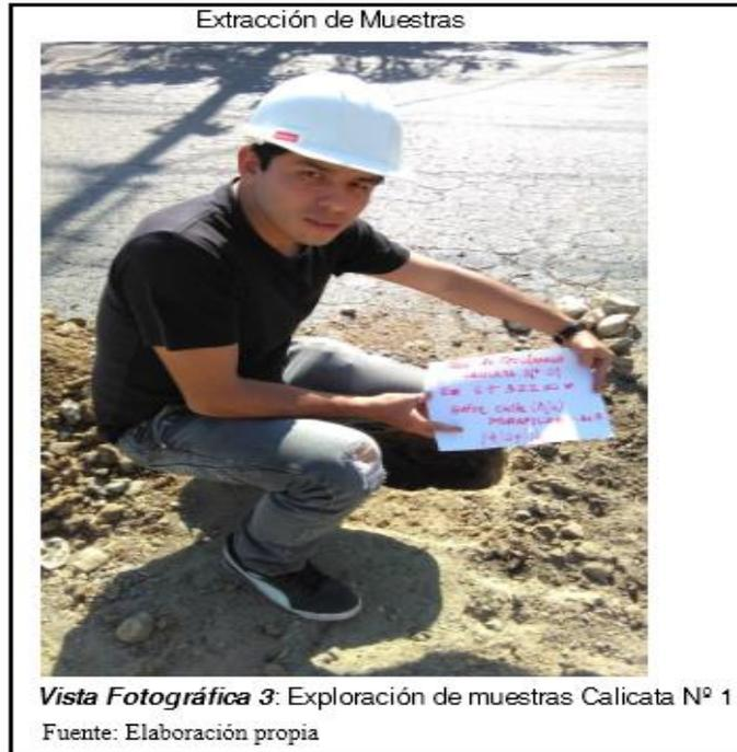
Se realizó esta exploración C1 en el km 0+322, para determinar el perfil estructural del pavimento flexible, se encontró nivel freático a 1.20 m de profundidad.
