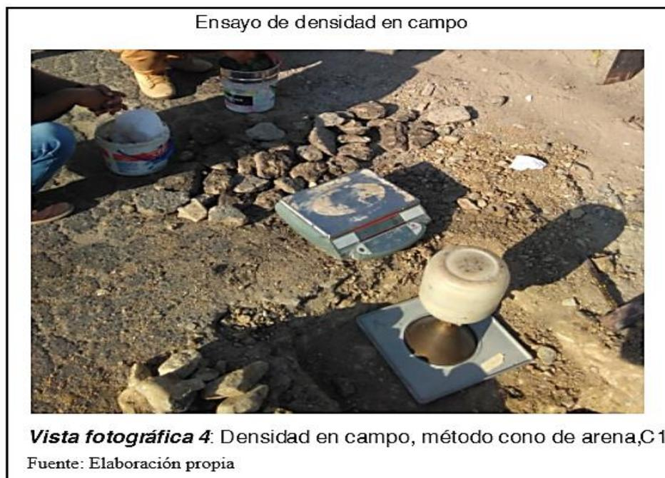
Se realizó este ensayo para cada una de las calicatas y cada de las capas estructurales del pavimento flexible (base y sub base), incluido la sub rasante, se utilizaron equipos de Laboratorio de Ensayo de Materiales (LEM) de la Universidad Señor de Sipán, otorgadas a los tesisistas, previa solicitud.
