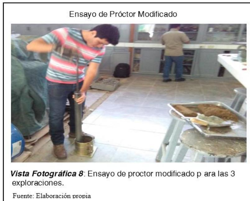
Se realizó este ensayo para las 3 muestras extraídas por el método "C", que consta con un molde de 6 pulg. de diámetro con 5 capas de 12, 25 y 56 golpes cada una. Este ensayo también se efectuó para las muestras de sub rasante.
