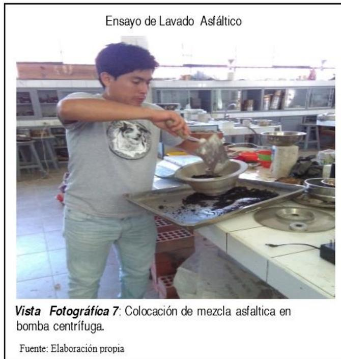
Previa realización de este ensayo se limpió las muestras de asfalto extraídas, luego se colocaron al horno por unos minutos y proceder a la disgregación para posteriormente colocar en la bomba centrífuga añadiéndose el tricloroetileno para realizar el ensayo.
