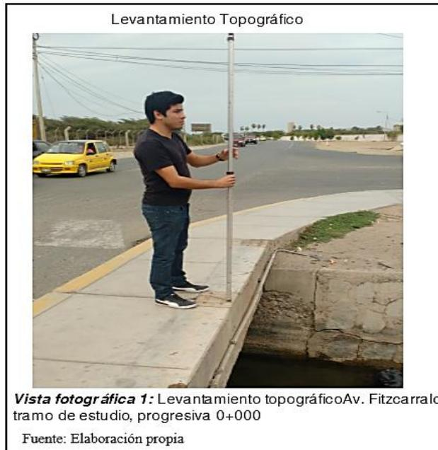
Para este estudio, se ubicó un BM-1 en la intersección de carretera Pomalca con Av. Fitzcarrald, con elevación de 40 m.s.n.m. La imagen muestra la ubicación del BM (eje de canal - Puente), sobre el canal Yortuque.
