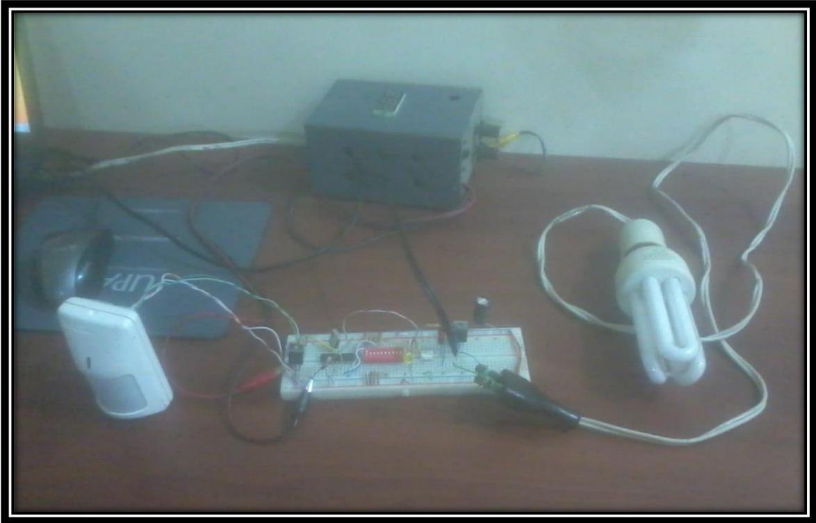
*Ilustración 29: Prueba del circuito en protoboard*
