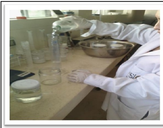
Adición del almidón y enzimas en frascos contenidos de 300 ml de agua destilada
