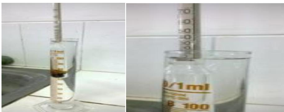
*Medición de grado alcohólico utilizando un alcoholímetro*
