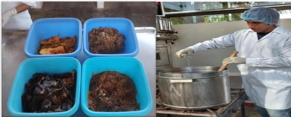
*Determinación del tratamiento: Hidrolisis Acida (75-80 °C) por 2h*
