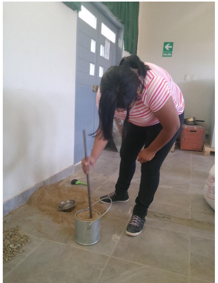
Foto 4: Peso unitario compactado del agregado fino (arena).
