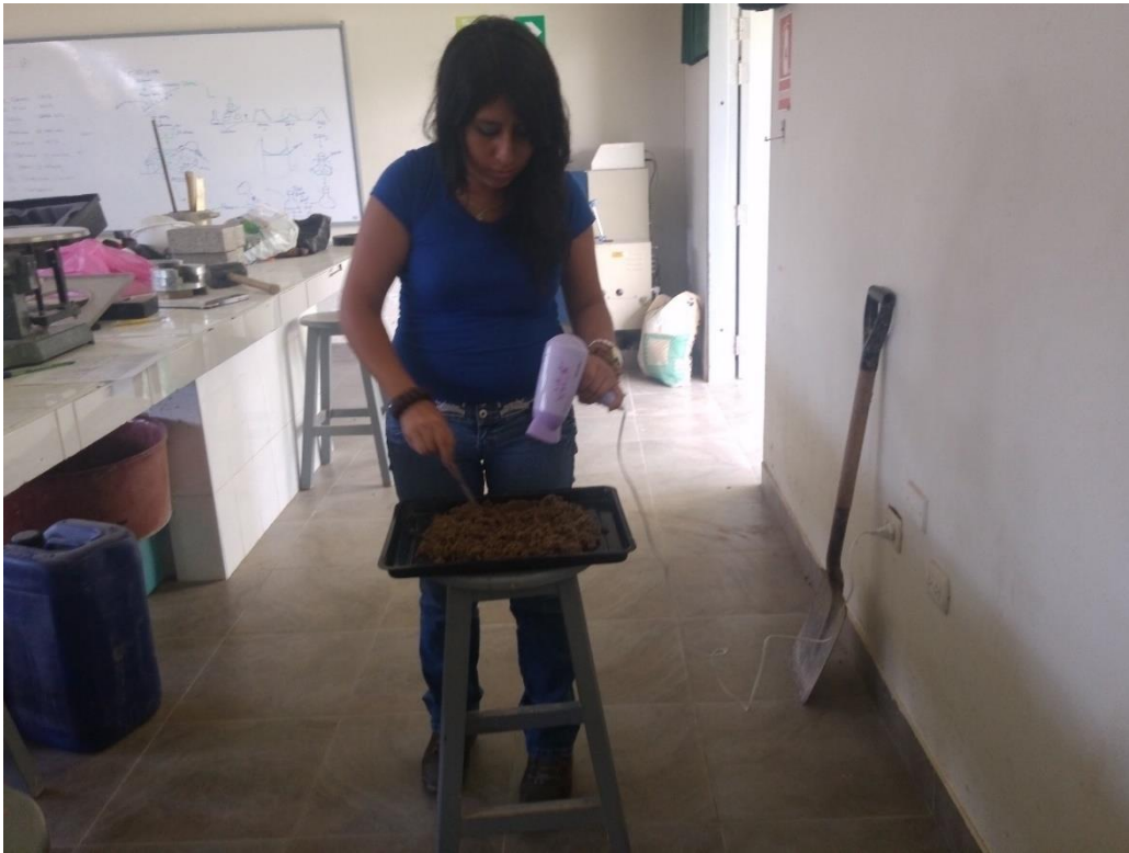
Foto 8: Agregado fino (arena) superficialmente seco
