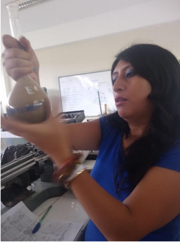
Foto 9: Agregado fino (arena) superficialmente seco en la fiola, se empieza a mover para sacar las burbujas de aire.
