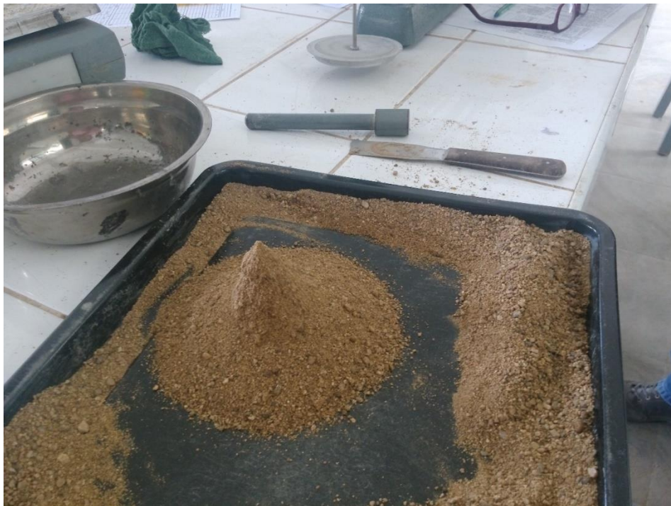
Foto 8: Agregado fino (arena) superficialmente seco
