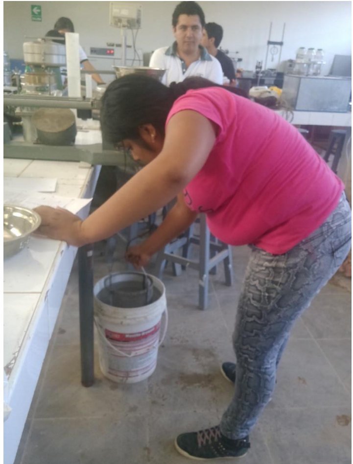
Foto 10: Realizando el peso del agregado grueso (piedra) sumergido en con un canastilla en agua
