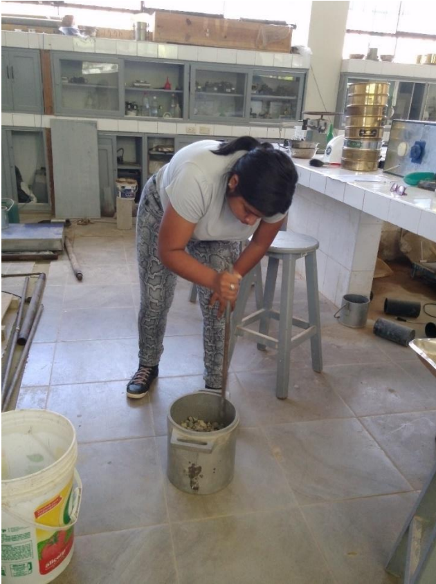
Foto 4: Peso unitario compactado del agregado fino (arena).
