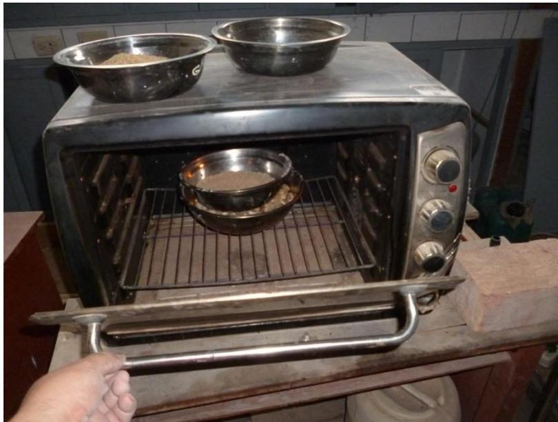
**Figura 49:** Muestra de agregado grueso secada en horno.
