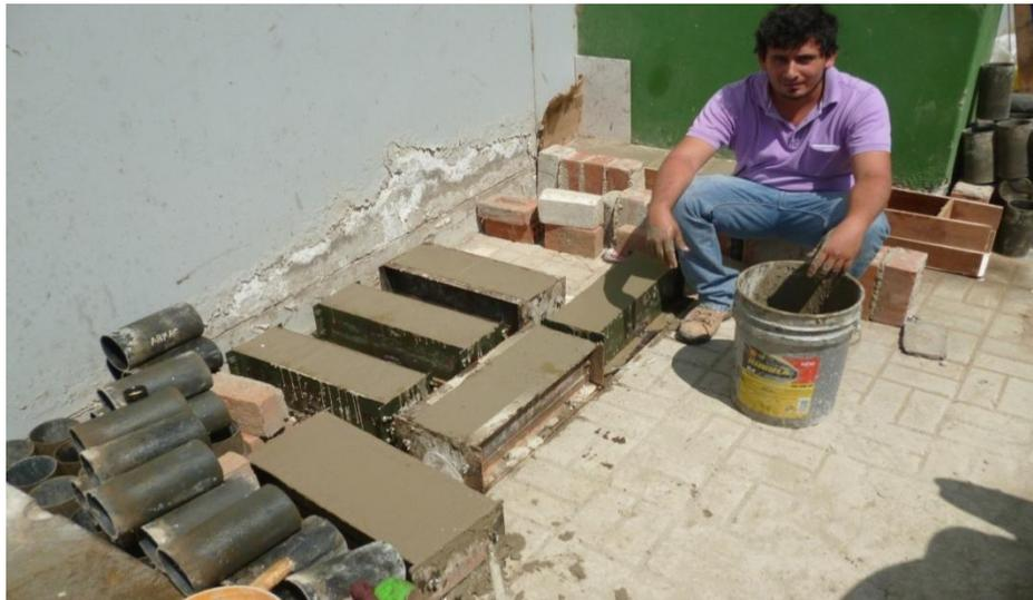
Llenado de vigas,  $f'c$  175 kg/cm<sup>2</sup> con adiciones de 0 y 200 gr/m<sup>3</sup> de fibra de polipropileno. Realizado en el Campus de la Universidad Señor de Sipán.
