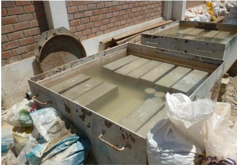
Vigas con  $f'c$  175, 210 y 280  $\text{kg}/\text{cm}^2$  con adiciones de 0, 200, 300 y 400  $\text{gr}/\text{m}^3$  de fibra de polipropileno, en poza de curado. Realizado en el Campus de la Universidad Señor de Sipán.
