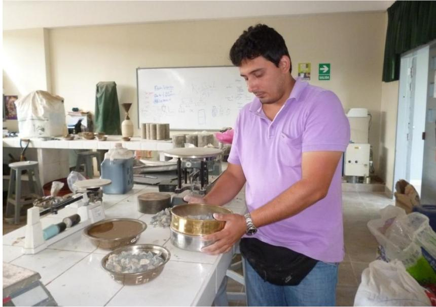
Granulometría del agregado grueso (piedra  $\frac{1}{2}$ "), realizado en el Laboratorio de Ensayo de Materiales de Universidad Señor de Sipán.
