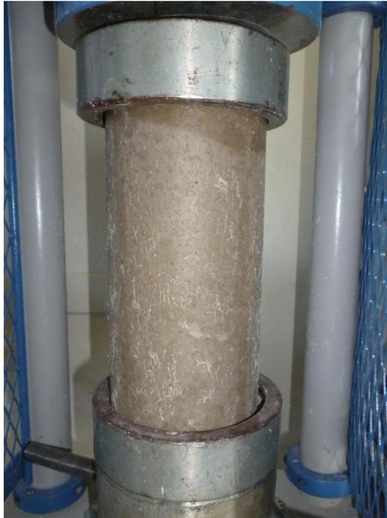
**Figura 29:** Especimen  $f'c$  280 kg/cm<sup>2</sup> con adición de fibra de polipropileno en dosis de 400 gr/m<sup>3</sup> 4 x 8 Pulg. Relación L/D = 2. Especimen en el interior de la Prensa Hidráulica.
