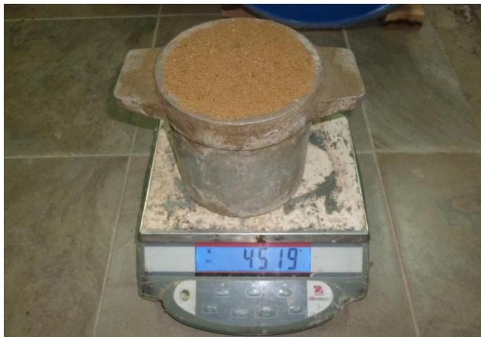
**Figura 42:** Peso de la muestra húmeda. Cálculo del peso unitario del agregado fino.
