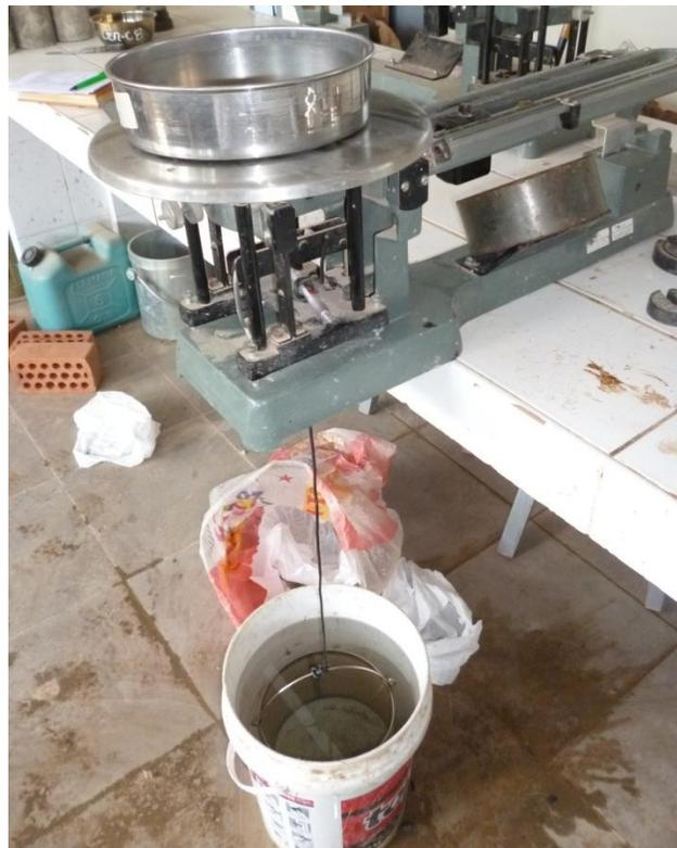
**Figura 48:** Equipo para ensayo de peso específico de agregado grueso.
