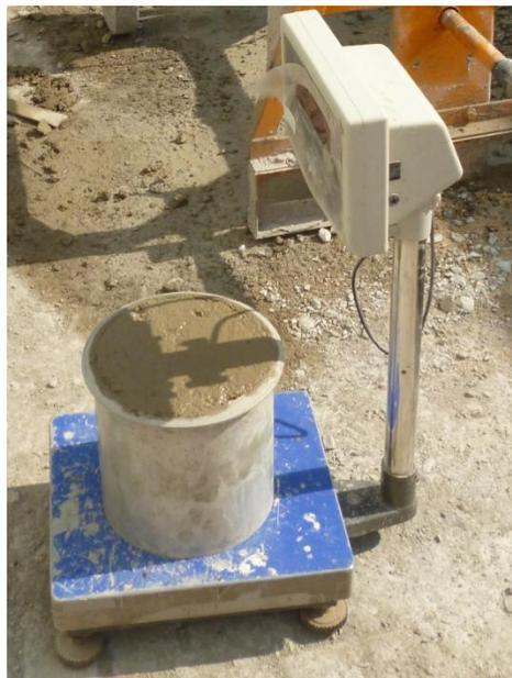
**Figura 19:** Ensayo de Peso Unitario. Peso de Concreto varillado más peso de olla.
