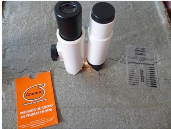
**Figura 55:** Equipo de medición de ancho de fisuras, fisurómetro y comparador de fisuras. Medición del Potencial de fisuración.
