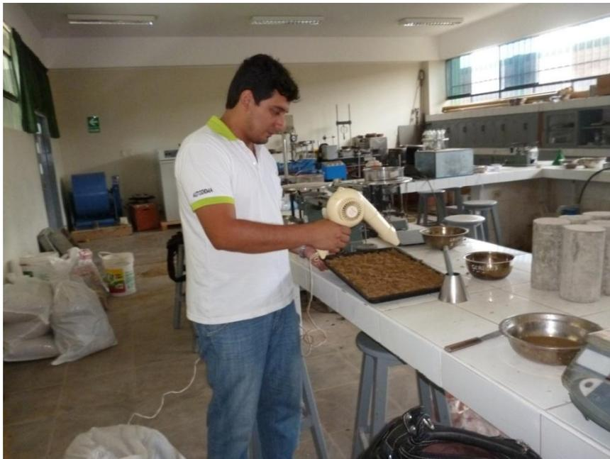
Peso específico y absorción del agregado fino, realizado en el Laboratorio de Ensayo de Materiales de Universidad Señor de Sipán.
