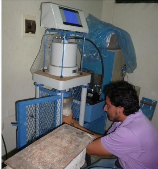
Rotura de probetas en prensa hidráulica. Realizado en el Laboratorio de Ensayo de Materiales de Universidad Señor de Sipán.
