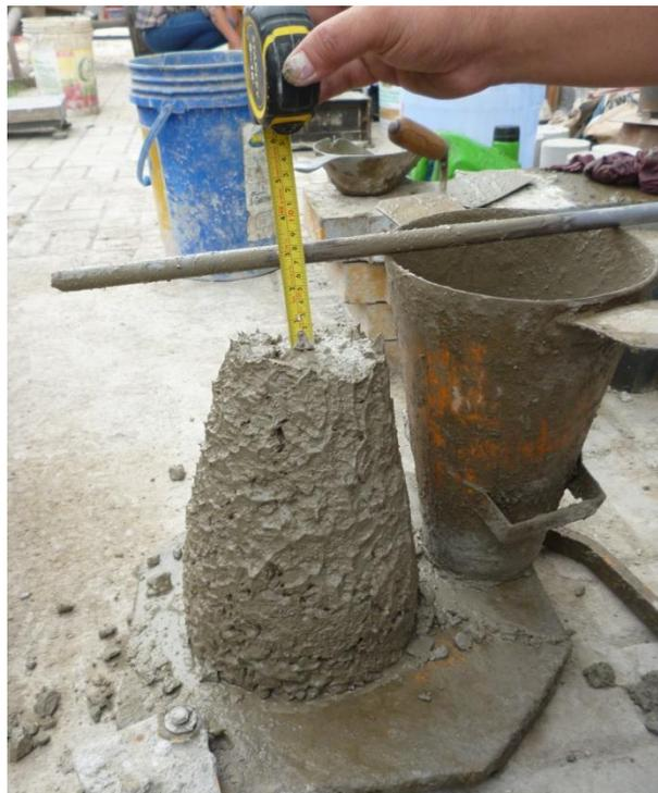
**Figura 18:** *Ensayo de Asentamiento. Medición del asentamiento.*
