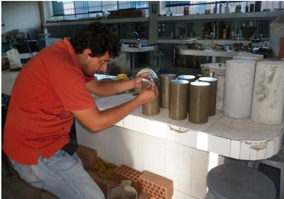
Medición del diámetro de probetas. Realizado en el Laboratorio de Ensayo de Materiales de Universidad Señor de Sipán.
