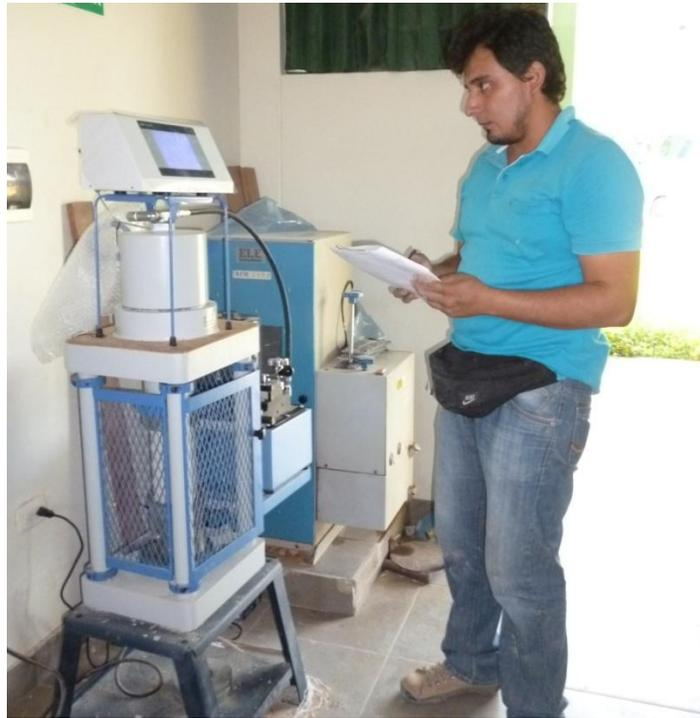
Registro de datos (fuerza a la que se produce la rotura) en rotura de probetas. Realizado en el Laboratorio de Ensayo de Materiales de Universidad Señor de Sipán.
