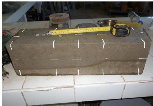
**Figura 32:** Viga  $f'c$  280 kg/cm<sup>2</sup> patrón, dimensiones 6 x 6 x 21 Pulg. Lista para ensayo.
