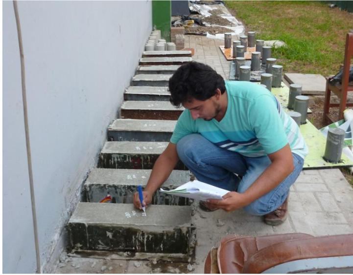
Colocación de códigos a vigas con  $f_c$  175, 210 y 280  $\text{kg/cm}^2$  con adiciones de 0, 200, 300 y 400  $\text{gr/m}^3$  de fibra de polipropileno. Realizado en el Campus de la Universidad Señor de Sipán.
