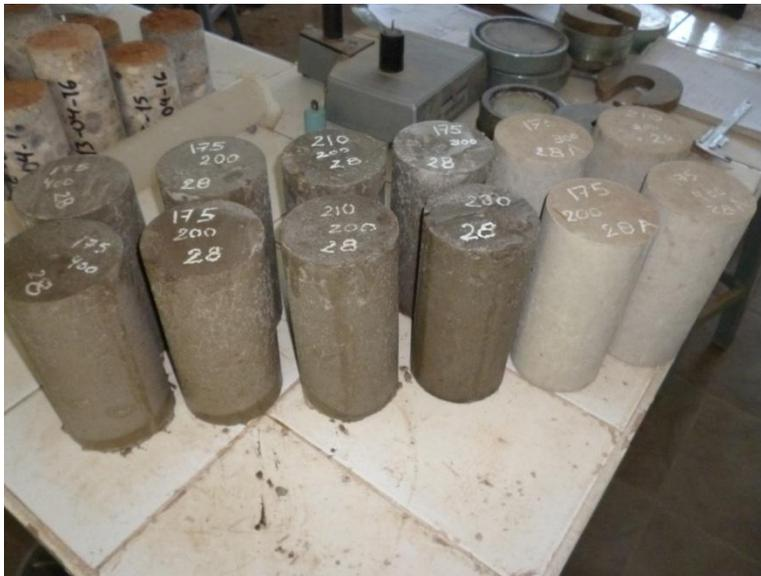
Probetas listas para rotura, cuatro últimas probetas de la derecha son blanquecinas debido al aditivo curador Membranil Reforzado. Realizado en el Laboratorio de Ensayo de Materiales de Universidad Señor de Sipán.
