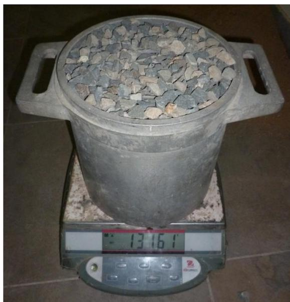
**Figura 47:** Peso de la muestra húmeda. Cálculo del peso unitario del agregado grueso.
