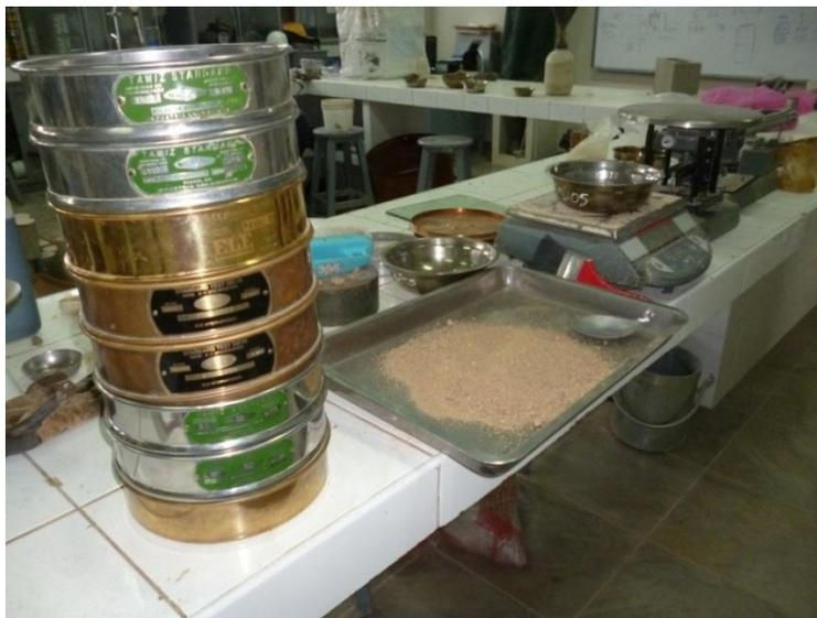
**Figura 41:** Tamices, N°3/8" hasta N°100 y depósito de fondo. Granulometría del agregado fino.
