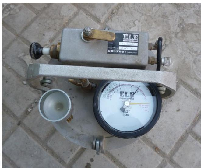
**Figura 20:** Ensayo de Contenido de aire.
