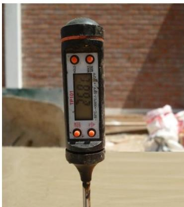
**Figura 21:** Temperatura del concreto fresco.
