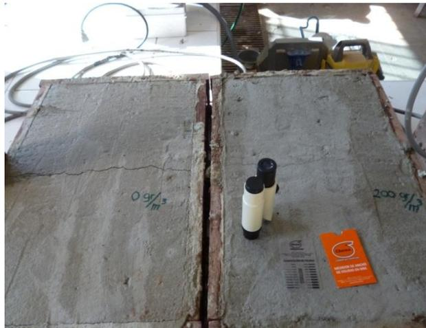
**Figura 54:** Medición del ancho de fisuras en muestras  $f'c$  280 kg/cm<sup>2</sup> con adiciones de fibra de polipropileno de 0 y 200 gr/m<sup>3</sup> en túnel de viento. Medición del Potencial de fisuración.
