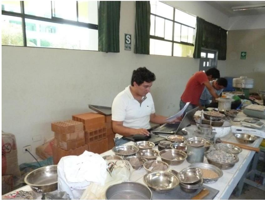
Reajustes del agua de mezcla en los diseños convencionales de 175, 210 y 280 kg/cm<sup>2</sup>.
