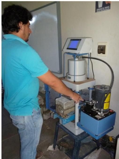
Rotura de vigas. Realizado en el Laboratorio de Ensayo de Materiales de Universidad Señor de Sipán.
