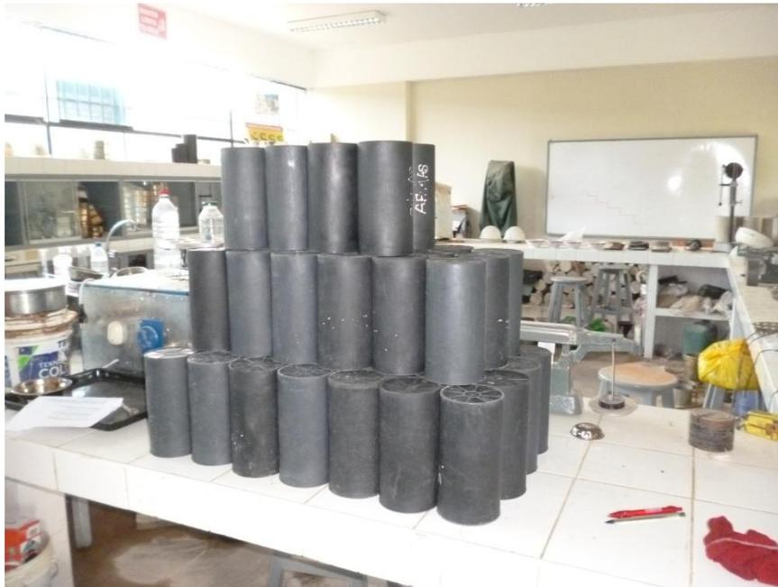
**Figura 28:** Moldes plásticos para probetas, dimensiones 4 x 8 Pulg. Relación  $L/D = 2$ .
