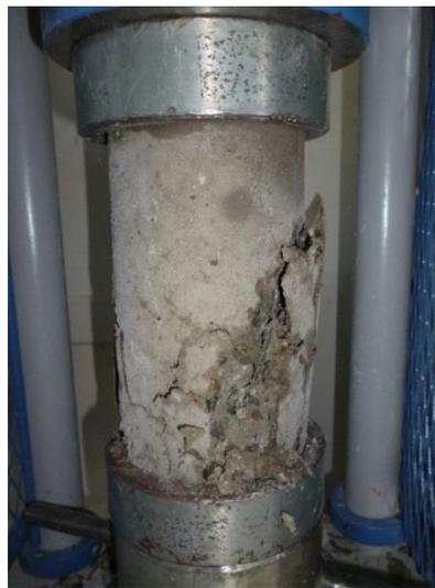
**Figura 62:** Modo de fractura de una probeta patrón  $f'c$  280 kg/cm<sup>2</sup>. Fractura frágil Tipo 1.
