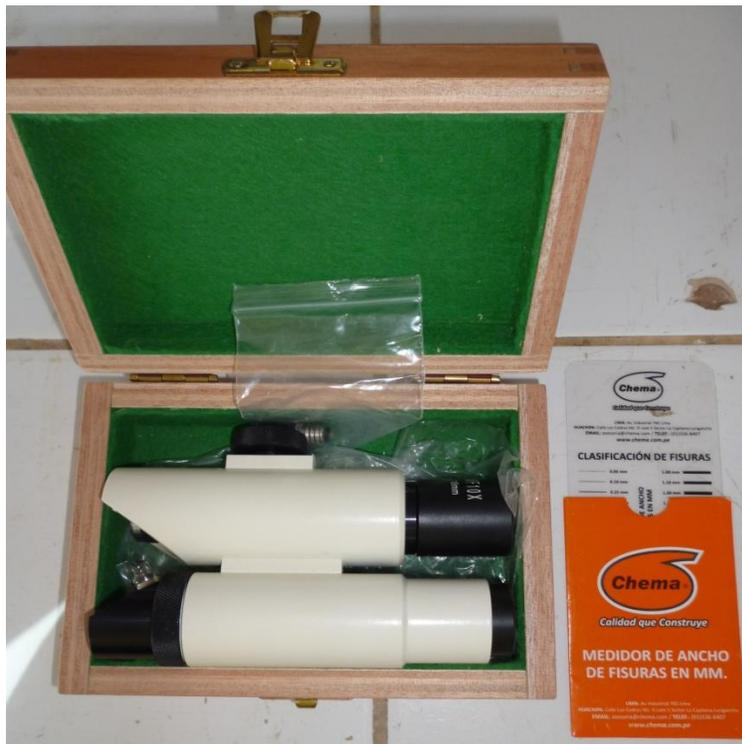
**Figura 26:** Equipo para medir ancho de fisuras. A la izquierda un fisurómetro electrónico, a la derecha un comparador de fisuras.
