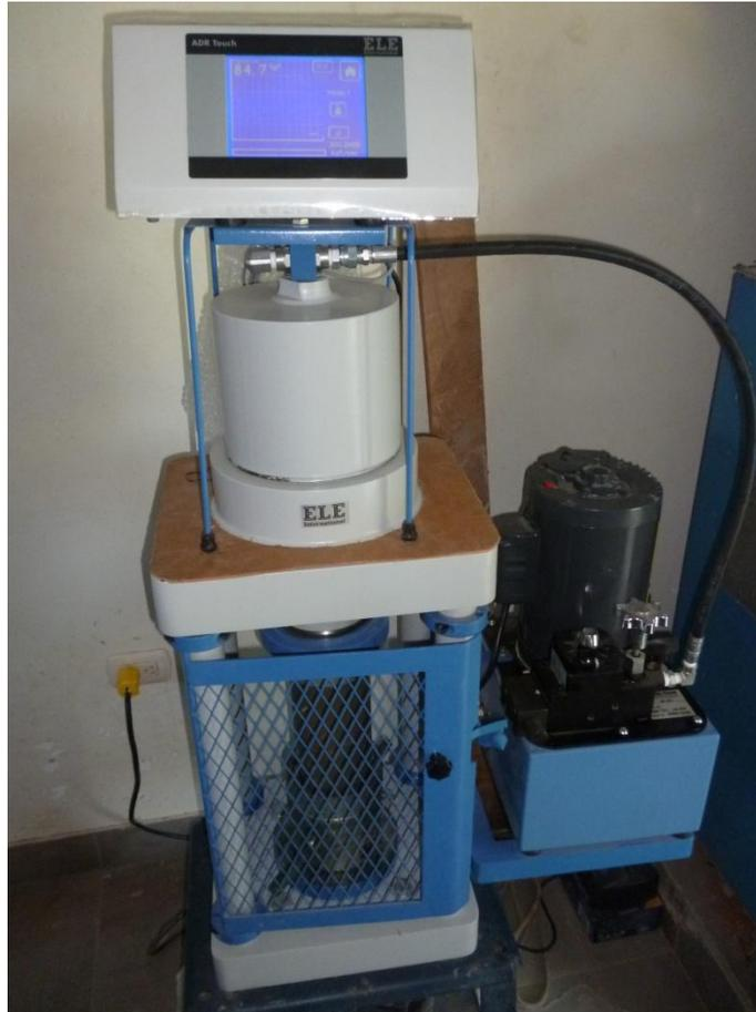
**Figura 27:** Equipo para medir resistencia a la compresión, Prensa Hidráulica.
