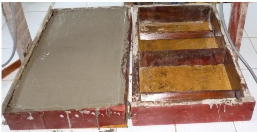
**Figura 24:** Moldes de fisuración. A la izquierda se aprecia un molde lleno de concreto, a la derecha se aprecia un molde vacío.
