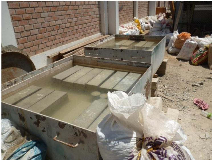
**Figura 35:** Cámara húmeda de curado de especímenes.
