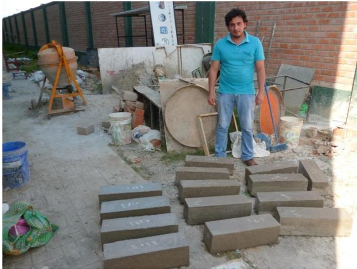
Vigas desmoldadas, con  $f'c$  175, 210 y 280 kg/cm<sup>2</sup> con adiciones de 0, 200, 300 y 400 gr/m<sup>3</sup> de fibra de polipropileno, listas para colocar en cámara de curado. Realizado en el Campus de la Universidad Señor de Sipán.
