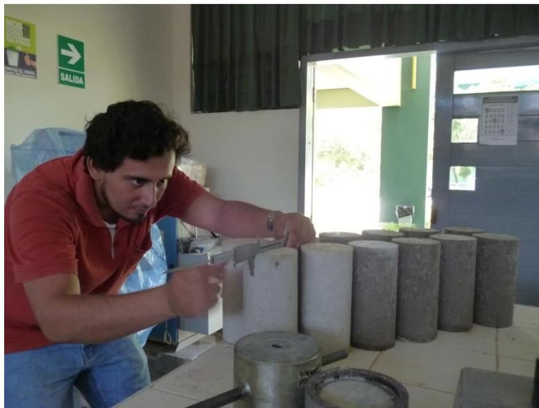
Medición de diámetros de probetas de 4 x 8 pulg. Realizado en el Laboratorio de Ensayo de Materiales de Universidad Señor de Sipán.
