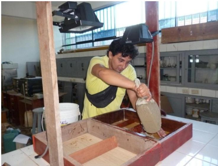
Llenado de losas en laboratorio, para ensayo de potencial de fisuración. Realizado en el Laboratorio de Ensayo de Materiales de Universidad Señor de Sipán.
