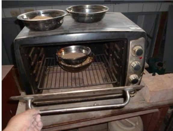
**Figura 44:** Muestra de agregado fino secada en horno.
