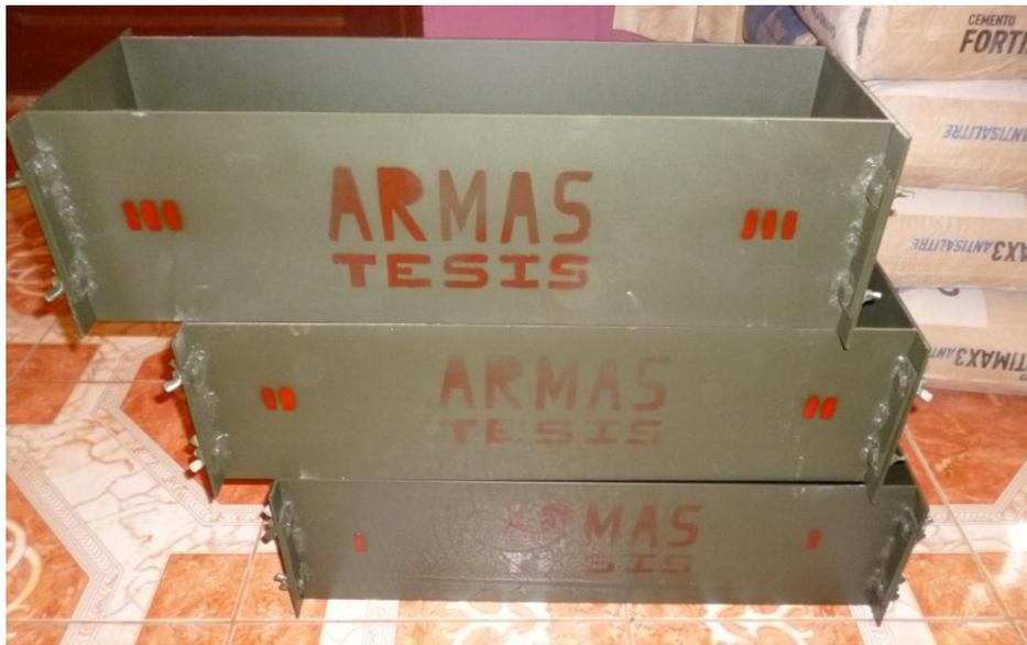
**Figura 31:** Moldes metalicos para vigas, dimensiones 6 x 6 x 21 Pulg.
