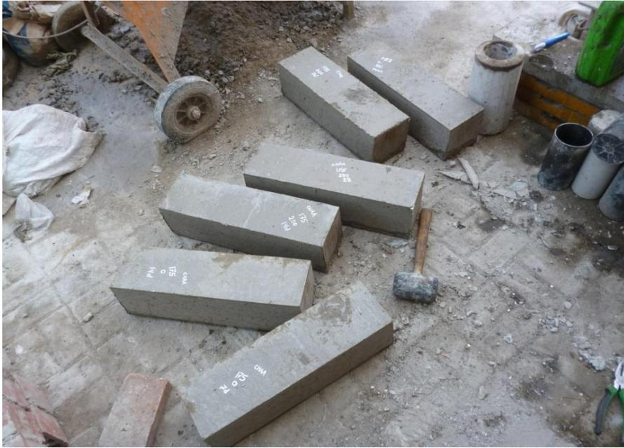
Desenfofrado de vigas,  $f'c$  175  $\text{kg}/\text{cm}^2$  con adiciones de 0 y 200  $\text{gr}/\text{m}^3$  de fibra de polipropileno. Realizado en el Campus de la Universidad Señor de Sipán.
