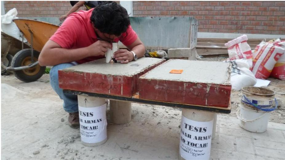
Medición de anchos de fisuras en losas de  $f'c$  175 kg/cm<sup>2</sup> en condiciones reales con adiciones de 0 y 400 gr/m<sup>3</sup> de fibra de polipropileno. . Realizado en el Campus de la Universidad Señor de Sipán.
