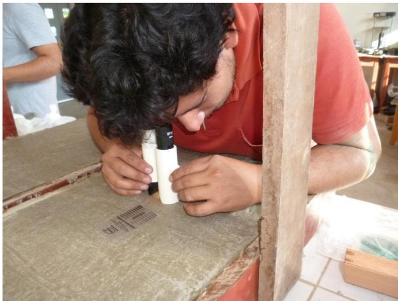
Medición de fisuras con Fisurómetro. Realizado en el Laboratorio de Ensayo de Materiales de Universidad Señor de Sipán.
