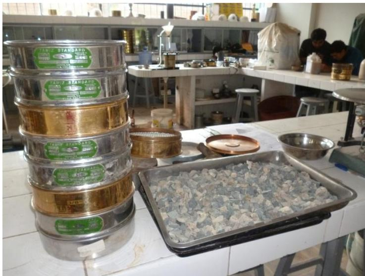
**Figura 46:** Tamices, N°2 " hasta N°4 y depósito de fondo. Granulometría del agregado grueso.
