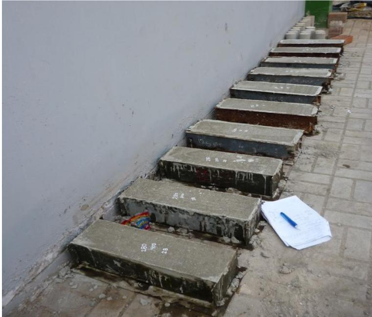
**Figura 34:** Vigas  $f'c$  280 kg/cm<sup>2</sup> con adiciones de fibra, dimensiones 6 x 6 x 21 Pulg.
