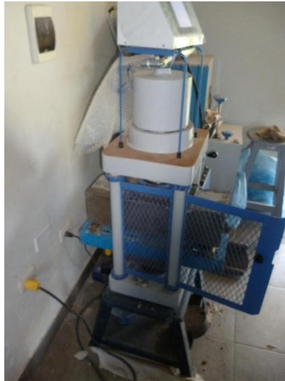
**Figura 36:** Ensayo de resistencia a la flexión, viga simplemente apoyada cargada en los tercios de la luz.
