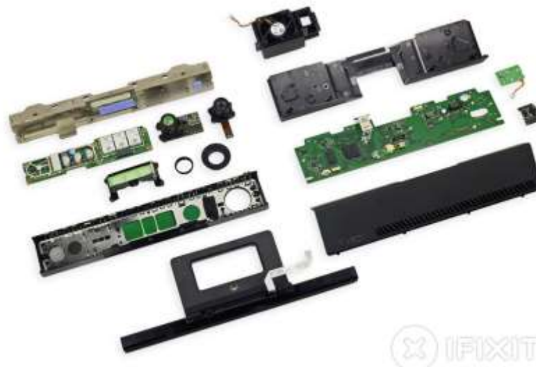
Figura 2. 2 Kinect desmontada en la que se ven todas sus piezas Fuente: (Zahumenszky, 2013)
