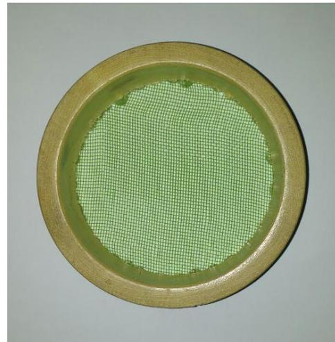
Fig. 8 Tamices de 2.8 mm y 1.4 mm de apertura.
