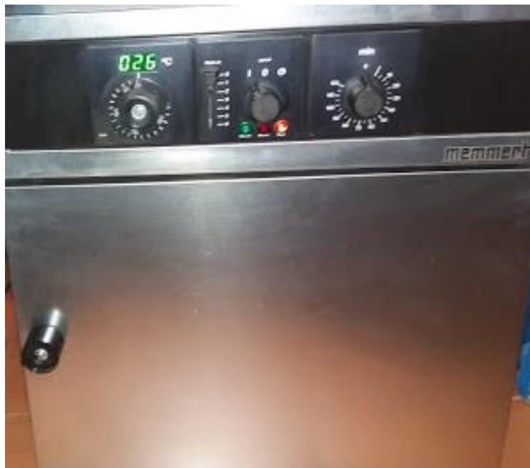
Fig. 6 Horno eléctrico para el secado de las partículas de silicona.
