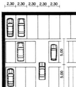
7 Plataformas de aparcamiento (Wöhr)
