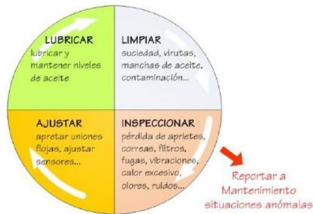
Figura 2. 162: Tareas del mantenimiento autónomo Fuente: Madariaga, F. (2013)
