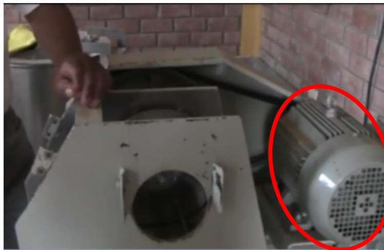
Figura N° 33: El motor de la Rodajera Industrial (sucio)
