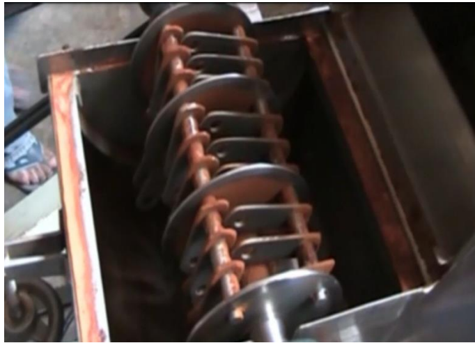
Figura N° 36: Cuchillas del molino de martillo
