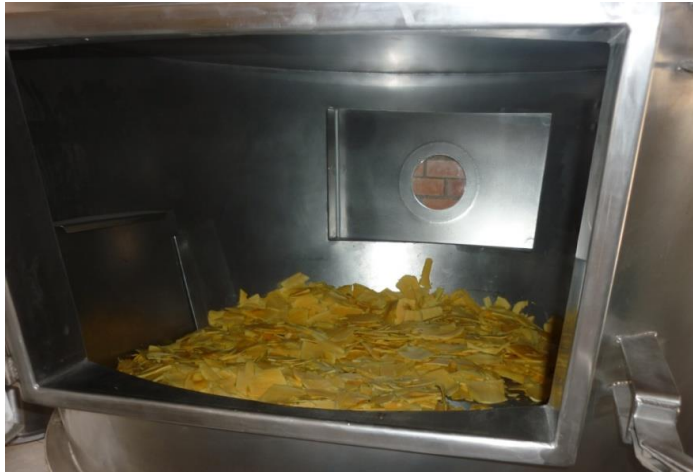
Figura N° 24: Entrada de loche laminado a la deshidratadora
