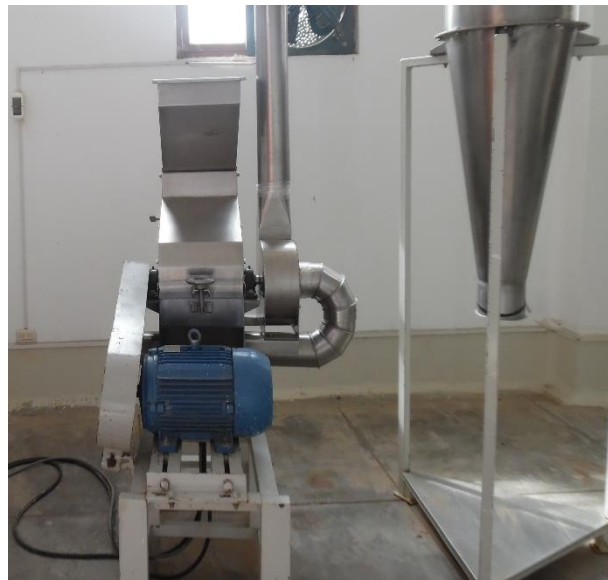
Figura N° 26: Molino de martillo donde sale loche en polvo
