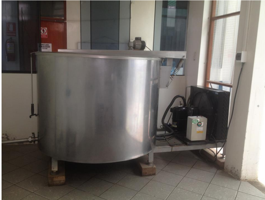
Figura 39: Tanque de refrigeración de leche
