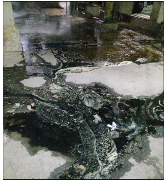
Figura D.1.86. Derrame de jugo clarificado.
