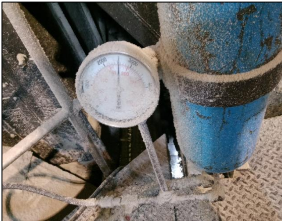
Figura D.1.61. Manómetros sucios.
