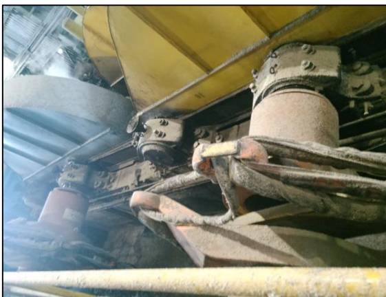
Figura D.1.57. Ajip de molinos cubiertos de bagacillo.
