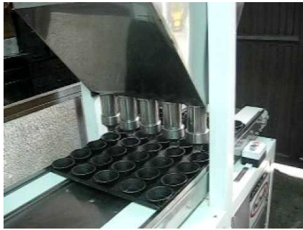
Figura 62 Vertido de Masa en Pirotín a Través de la Dosificadora
