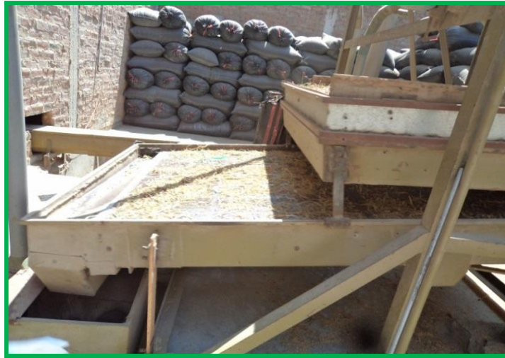
Figura 63: Máquina separadora donde se separa el arroz de la pajilla.
