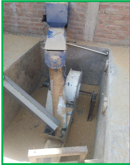
Figura 71: Máquina de briquetas de cáscara de arroz industrial.
