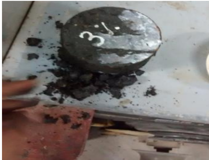
Briqueta con 3% de fibra de polietileno (tipo 2)
