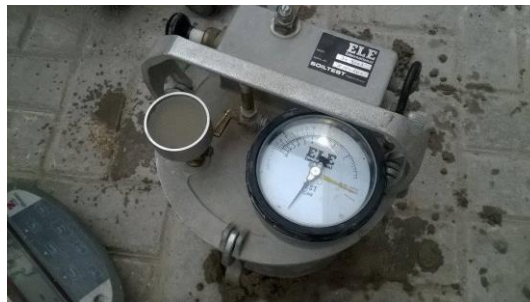
Foto N° 16 Toma de lectura visual - Ensayo contenido de aire
