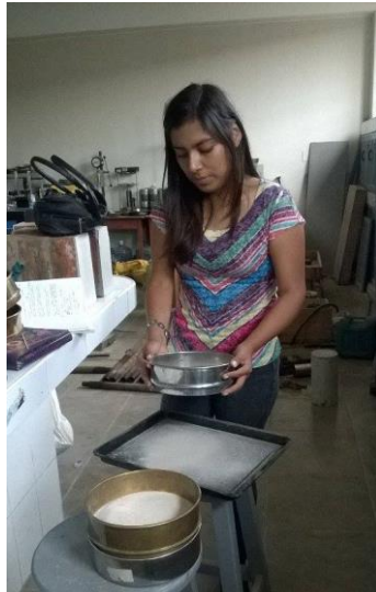
Foto N° 8 Tamizado del agreg. Fino de barita – Ensayo granulometría
