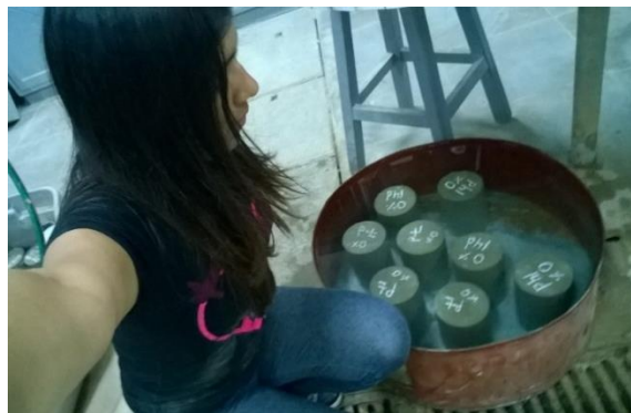
Foto N° 13 Curado de especímenes - concreto convencional
