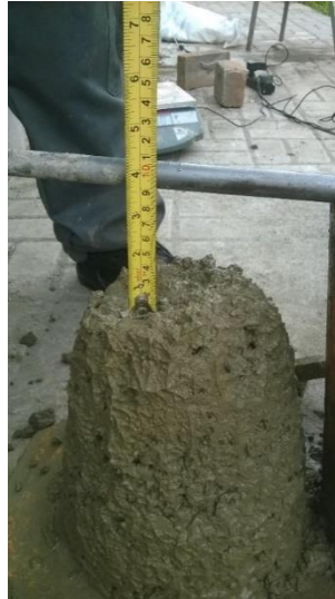
Foto N° 16 Toma de lectura visual - Ensayo contenido de aire
