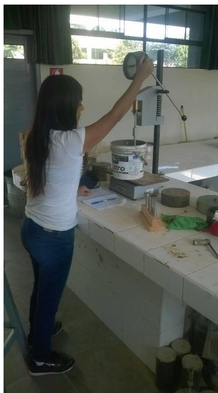
Foto N° 19 Aparato de Vicat - Ensayo tiempo de fraguado
