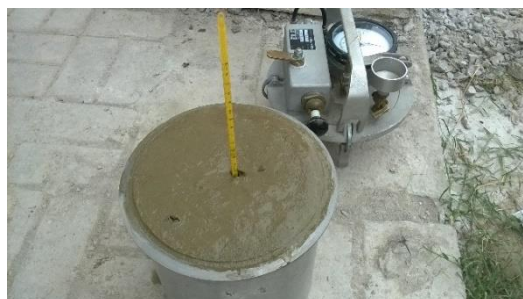
Foto N° 17 Toma de lectura del termómetro – Ensayo temperatura
