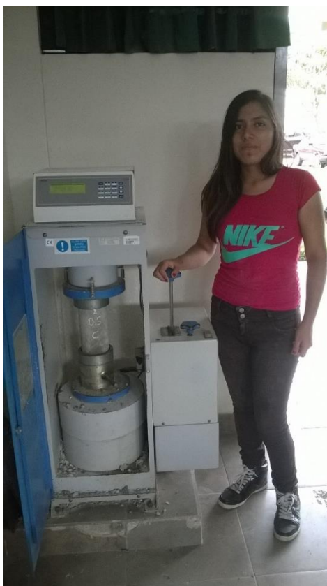
Foto N° 20 Rotura de probeta cilíndrica - Ensayo resistencia a la compresión
