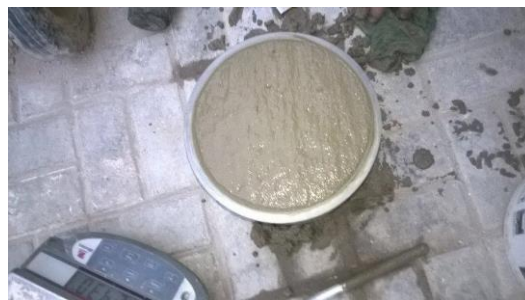
Foto N° 14 Muestra pesada - Ensayo peso unitario
