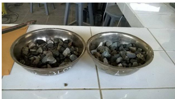
Foto N° 3 Muestra húmeda de agreg. Grueso - Ensayo contenido de humedad
