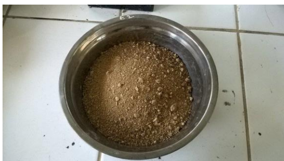
Foto N° 2 Muestra húmeda de agreg. Fino - Ensayo contenido de humedad
