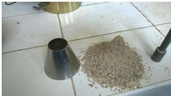
Foto Nº 4 Agregado fino de barita muestr. sat. sup. seca – Ensayo peso específico y % de absorción
