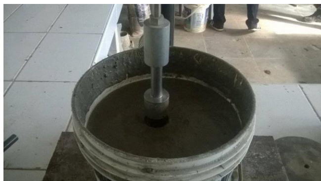
Foto N° 19 Aparato de Vicat - Ensayo tiempo de fraguado
