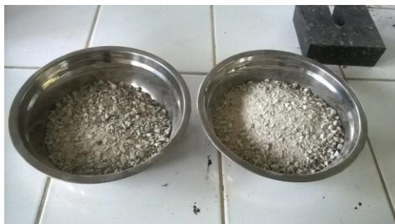
Foto N° 1 Muestra húmeda de barita - Ensayo contenido de humedad
