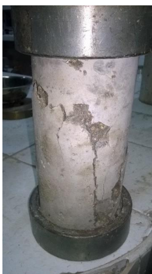
Foto N° 21 Falla de la probeta de concreto
