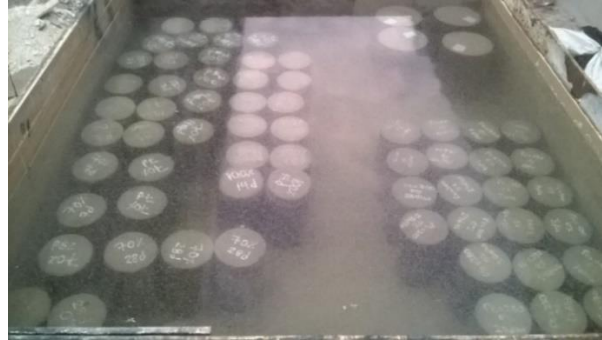
Foto N° 13 Curado de especímenes - concreto convencional
