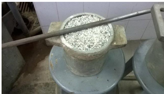
Foto Nº 6 Enrasando muestr. de barita - Ensayo Peso volumétrico varillado
