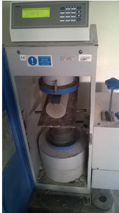
Foto N° 22 Rotura de probeta cilíndrica - Ensayo resistencia a la tracción por compresión diametral
