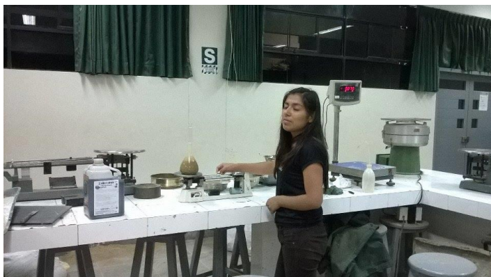
Foto Nº 6 Enrasando muestr. de barita - Ensayo Peso volumétrico varillado
