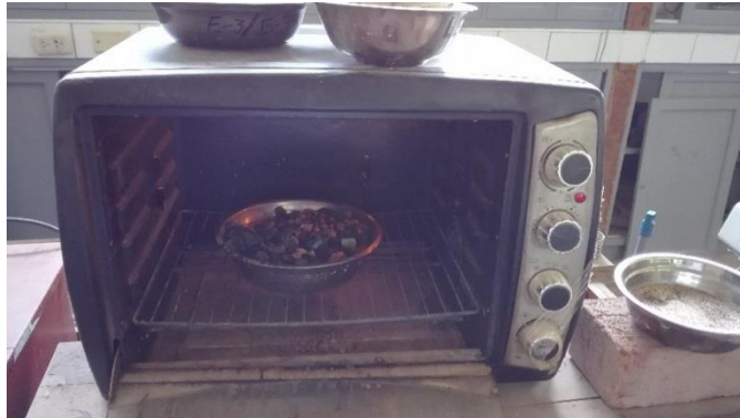
Figura N° 30: Secado del agregado grueso en el horno a T° 110.
