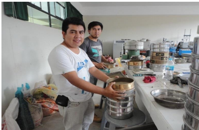
Figura N° 16: Realizando el tamizado de agregados.
