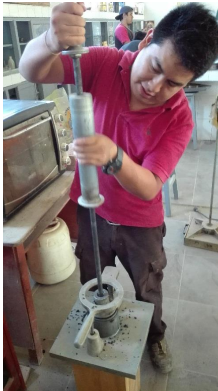
Figura N° 39: Aplicación los golpes a la briqueta.
