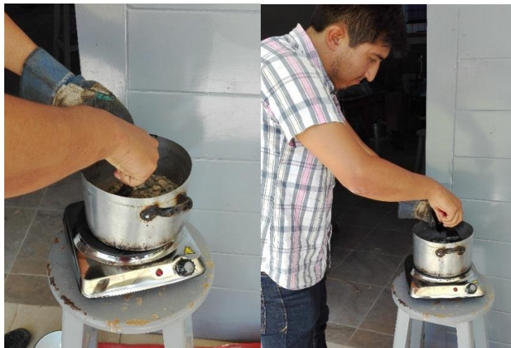
Figura N° 37: Mezclado de los agregados más asfalto.
