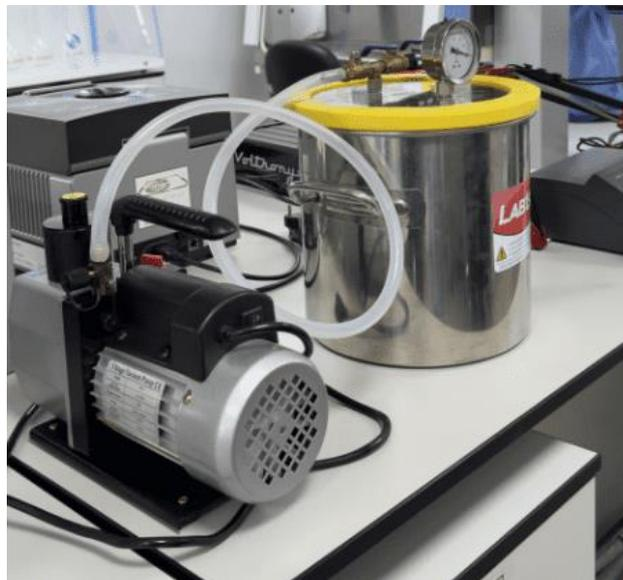
**Fig. I.** Equipo de impregnación al vacío
