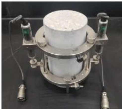
Figura 3. Muestra cilíndrica de concreto en el compresómetro, adaptado de [29]
