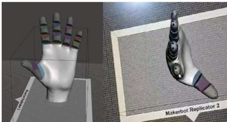
Ilustración 29 Prótesis unido por corte de 45° dedo y orificios de unión Fuente:[40].
