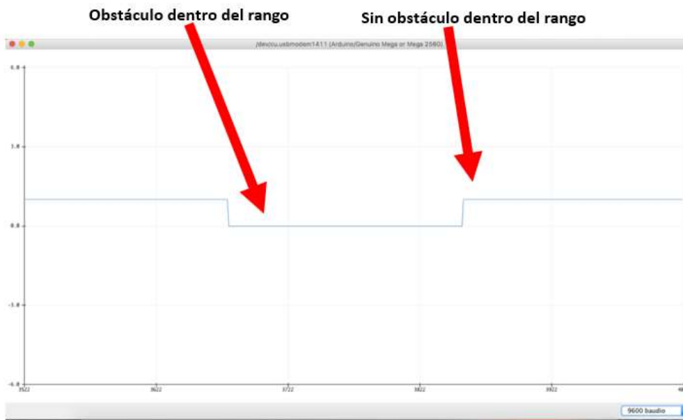
Fig. 9 Gráfico de la función Serial Plotter para el sensor de proximidad
