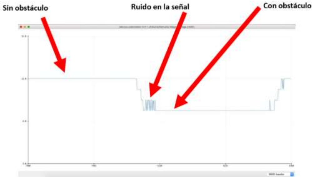
Fig. 11 Gráfico de la función Serial Plotter para el sensor Sharp.
